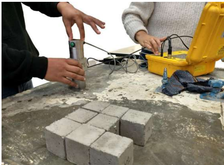
Figura 4. Medición de la velocidad de pulso ultrasónico.. Foto: Tomada por el autor.
