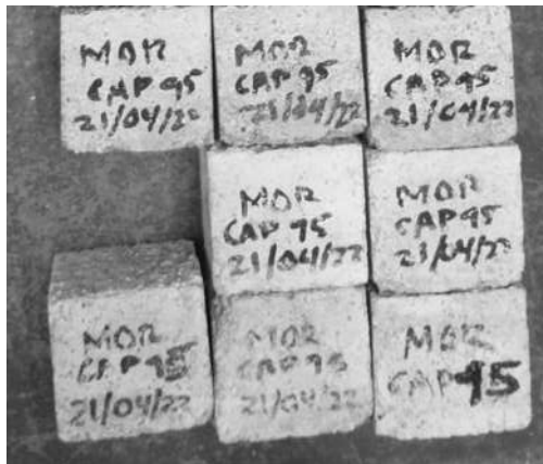
Figura 34. Mortero de cal con contenido de hidróxido de calcio 95 - arena volcánica.
