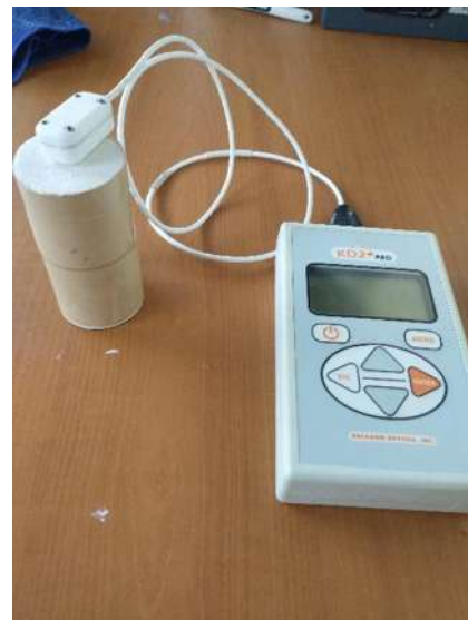
Figura 54. Prueba de conductividad térmica. Foto: tomada por el autor.
