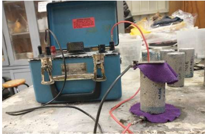
Figura 3. Aparato para medir la resistividad eléctrica. Foto: tomada por el autor
