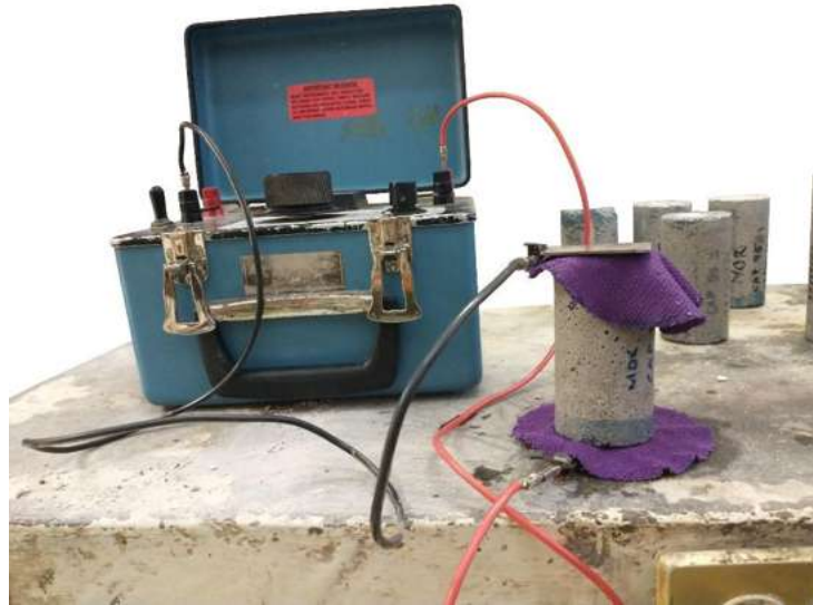
Figura 50. Prueba de resistividad eléctrica. Foto: tomada por el autor
