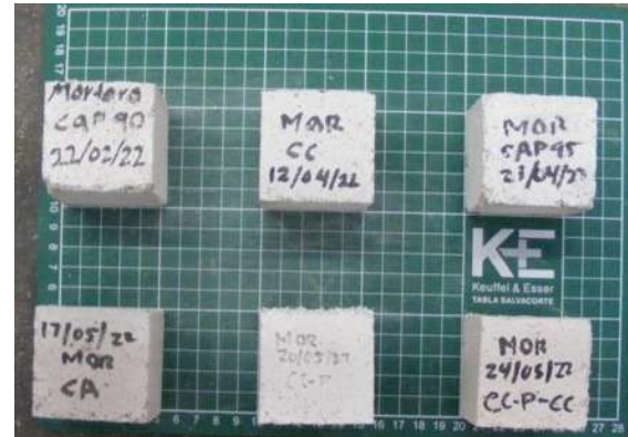
Figura 39. Vista de dimensiones de los cubos de los morteros. Foto: tomada por el autor.
