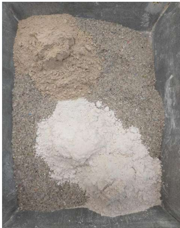
Figura 27. Mezcla en seco de cal, carbonato de calcio y PET.. Foto: tomada por el autor.
