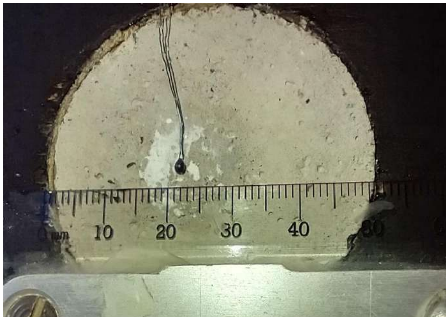
Figura 75. Ubicación del termopar en el espécimen. Foto tomada por el autor.
