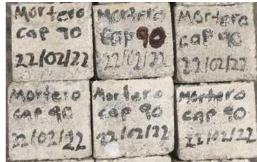
Figura 33. Mortero de cal con contenido de hidróxido de calcio 90 - arena volcánica.
