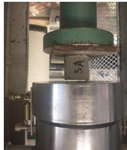
Figura 5. Prueba de resistencia a la compresión. Foto: tomada por el autor.
