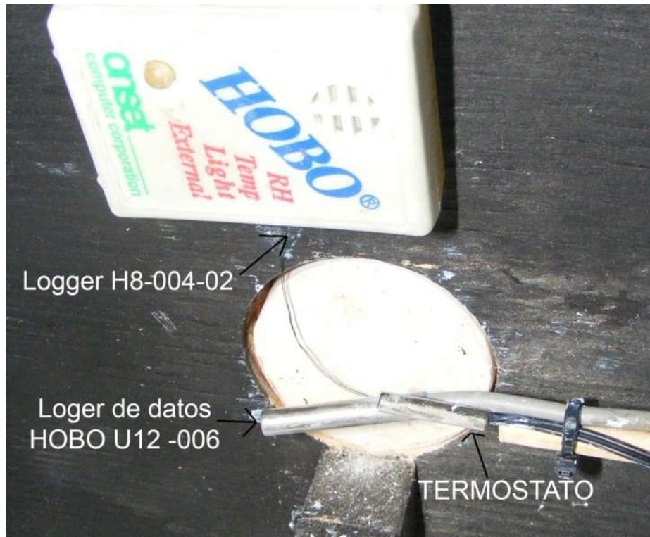
Figura 83. Termopares en el espécimen. Foto tomada por el autor.
