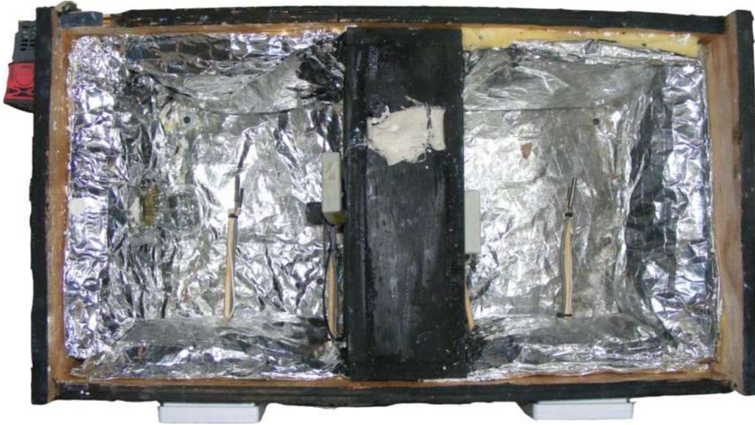
Figura 68. Caja caliente construida. Foto tomada por el autor.
