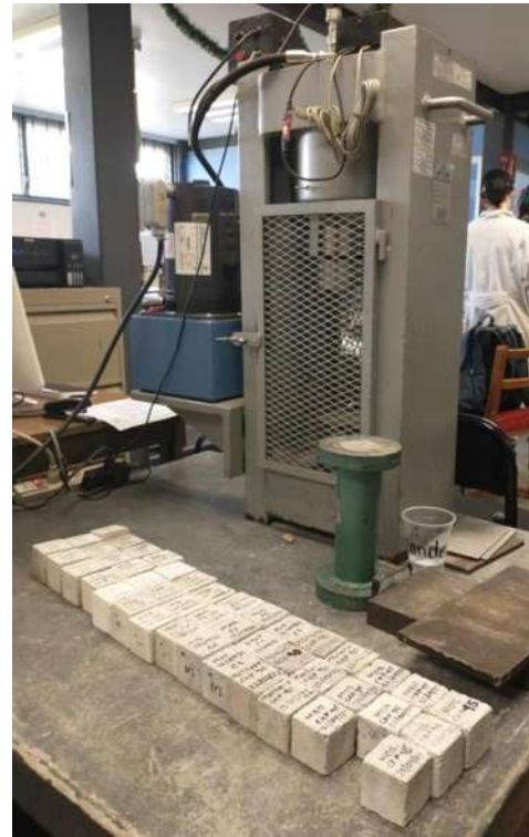
Figura 59. Prueba de resistencia a la compresión. Foto: tomada por el autor.
