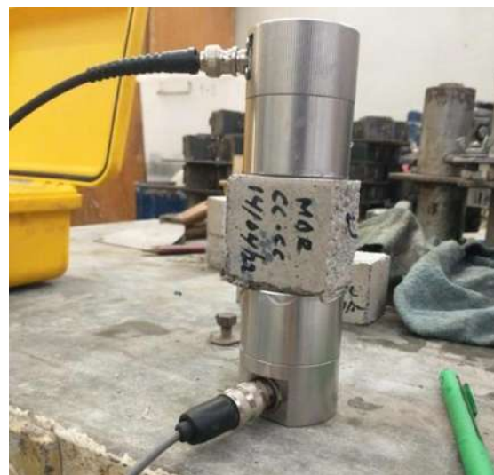
Figura 52. Prueba de velocidad de pulso ultrasónico. Foto: tomada por el autor.
