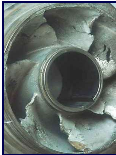
Figura 2.11: Rodete erosionado por cavitación; obtenido de [Ayuso et al. (2004)].
