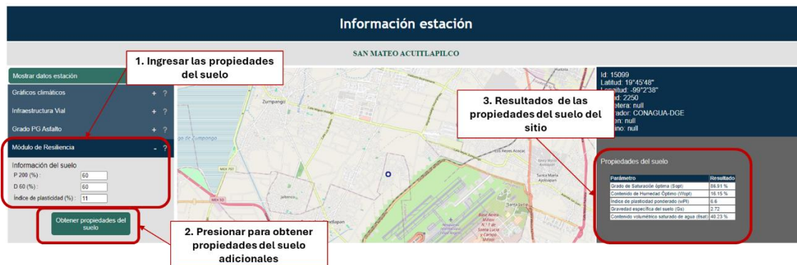
Figura 4.2 Selección de la estación climatológica y del aplicativo para estimar el Módulo de resiliencia.
