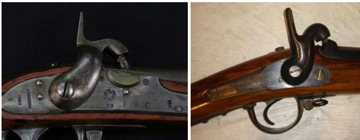
Derecha: Llave de chispa reconvertida a percusión. Izquierda: Llave de percusión estilo francés.
