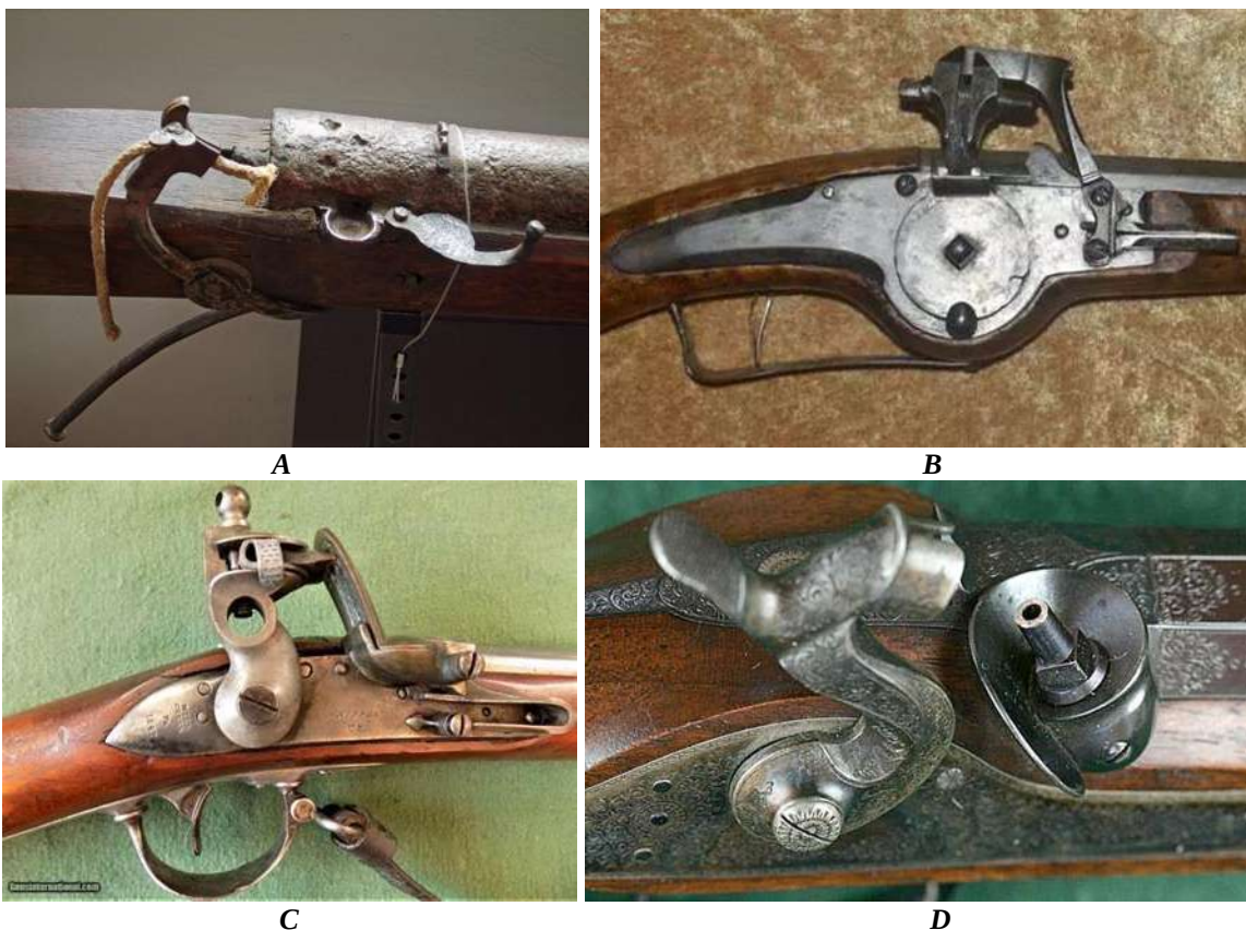
Llaves de disparo para armas de fuego utilizadas desde el siglo XV al XIX. A. Llave de mecha o serpentín – Matchlock –; B. Llave de rueda – Whellock –; C. Llave de pedernal o chispa – Flintlock – y D. Llave de percusión o pistón – Percussion lock –. 7
