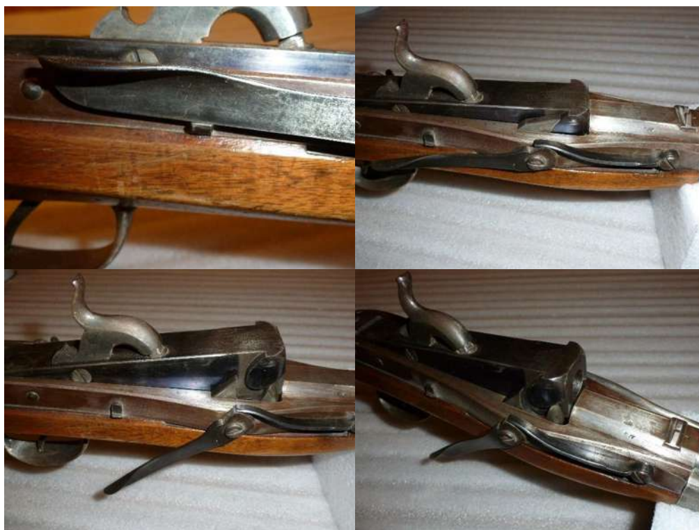
Secuencia de pasos para abrir la recámara del sistema Hall.
