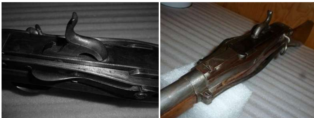
Vistas desde arriba y en ángulo del mecanismo de la carabina Hall.
