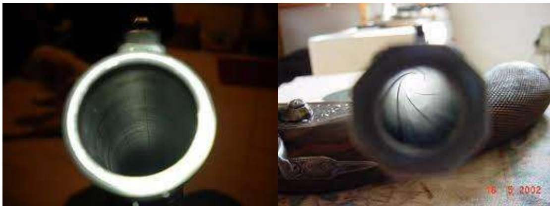
Comparación de dos cañones: a la izquierda, uno de ánima lisa y a la derecha, uno de ánima rayada.
