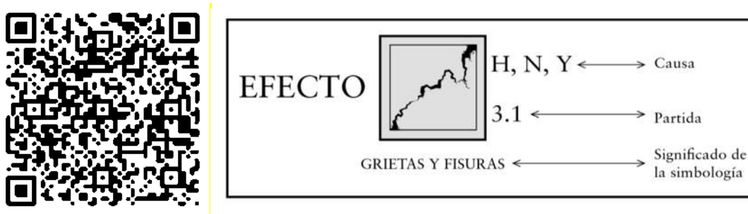
Ilustración 43 Simbología utilizada para planos de levantamiento de alteraciones y deterioros generales. RILM.
