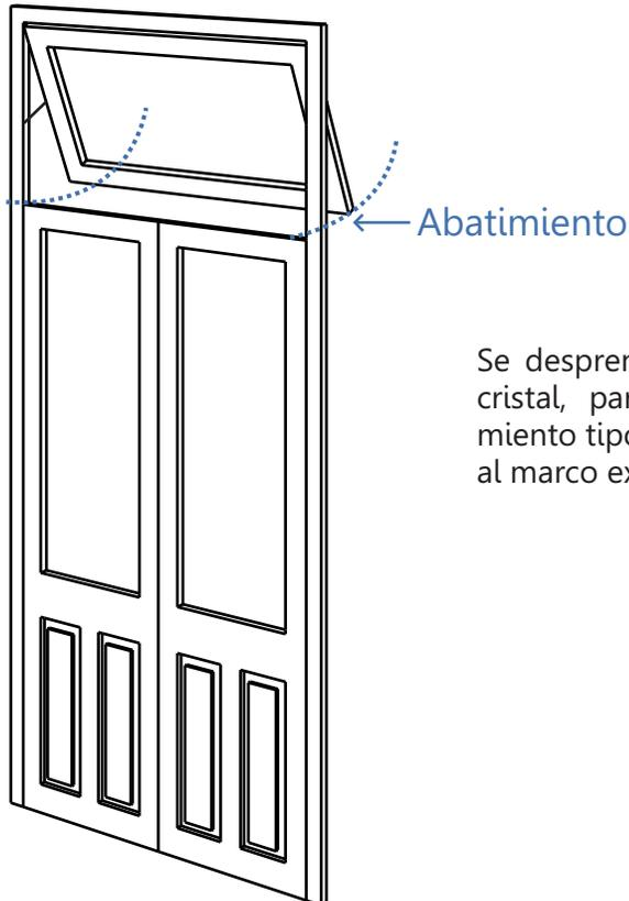
Se desprenderá el maro superior de la ventana en conjunto con el cristal, para posteriormente colocar bisagras y sistema de abatimiento tipo toldo en dicha pieza. Finalmente se atornillará nuevamente al marco existente.
