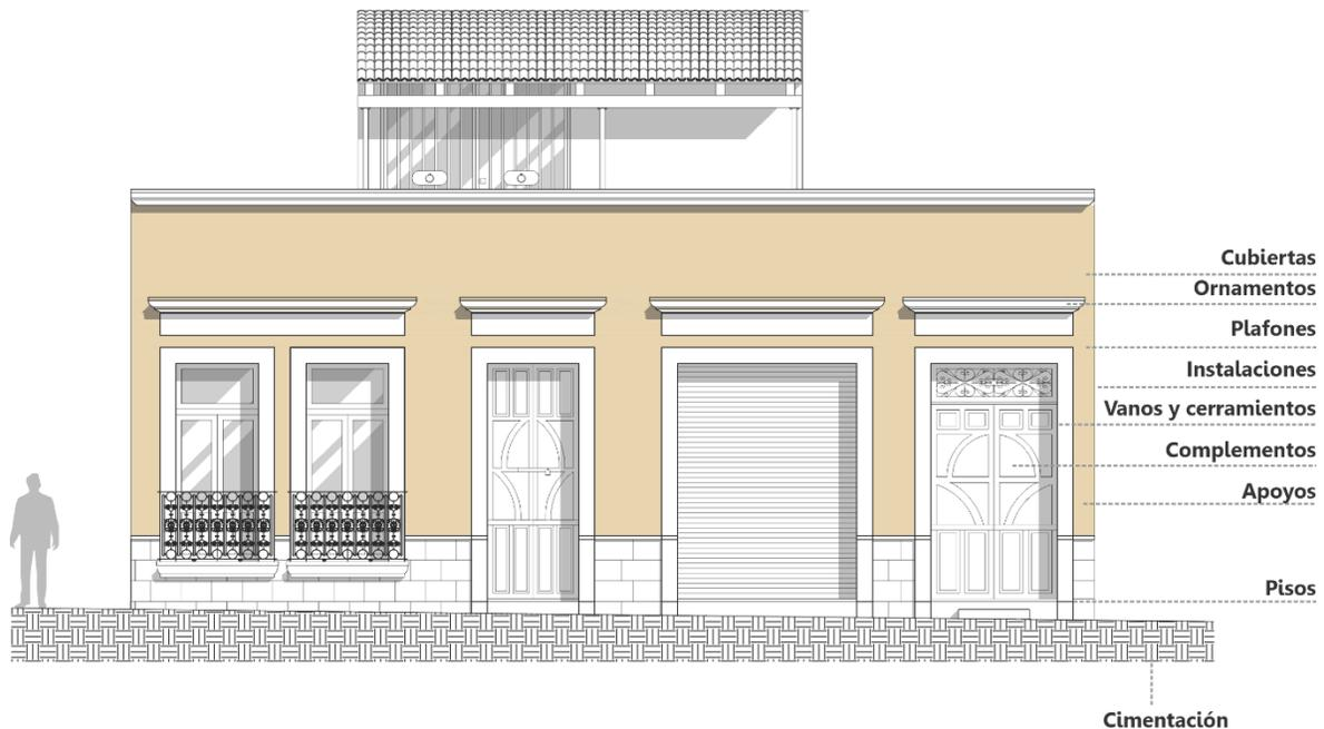
Imagen 69 Determinación de partidas para realización de levantamiento de materiales y sistemas constructivos. Elaborada por KNV.
