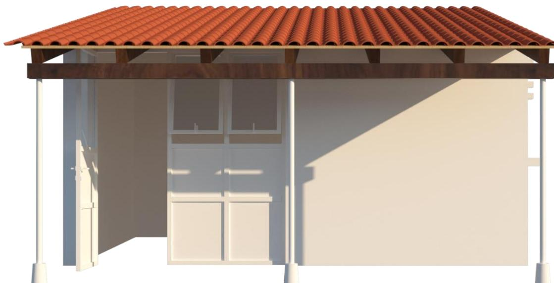
*Imagen 146 Detalle de habitación 3 donde se aprecia diseño de puerta con abatimiento de ventanas y diseño por mimetismo. Elaborado por KNV.*
