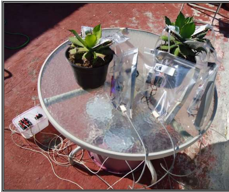
Figura 5. Medición de intercambio de gases con el primer prototipo de MACsuino, en dos plantas de A. cupreata durante ocho días.
