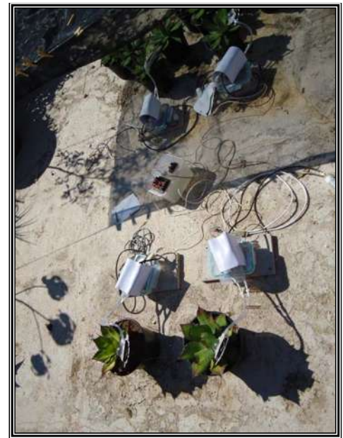
Figura 6. Periodo de aclimatación (a) y periodo de mediciones de intercambio de gases (b) con los MACsuinos en dos plantas aclimatadas a la sombra y en dos plantas aclimatadas al sol.
