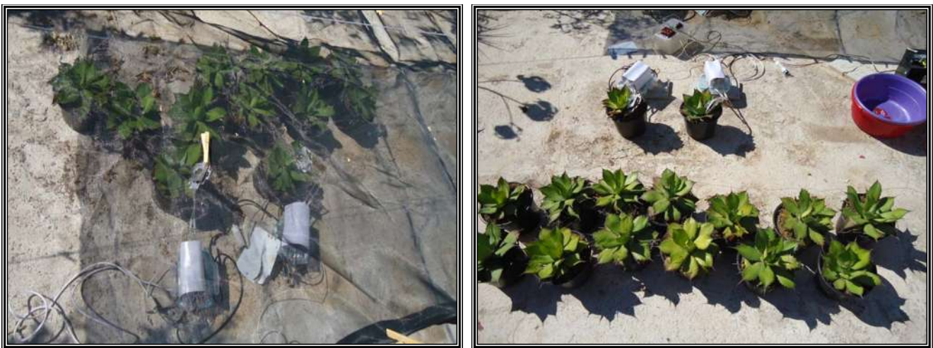
Figura 15. Medición de intercambio de gases en hojas de A.cupreata aclimatadas a la sombra y al sol, en el tercer experimento.
