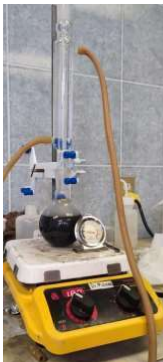
Fig. 3.1. Sistema de reflujo utilizado para la oxidación de grafito.
