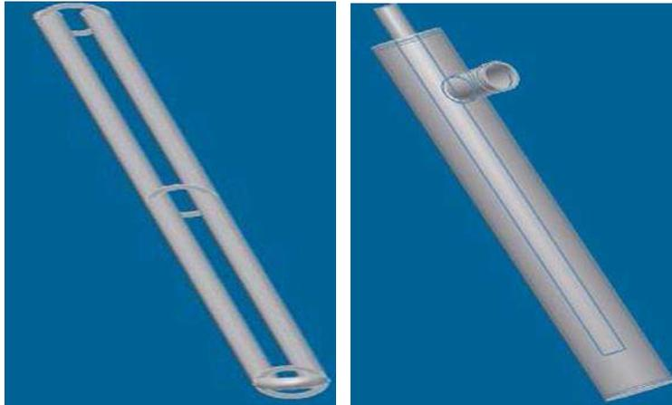
**Figura 1.2:** Sistema de bombeo *airlift* con tubo en U a la izquierda y con tubo ascendente a la derecha.
