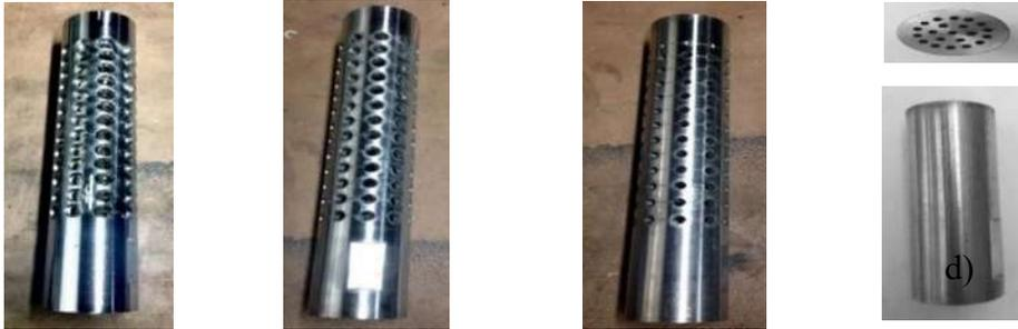
**Figura 2.9: Inyectores de gas que se instalaron en el extremo inferior del sistema *airlift* con diferentes áreas totales de inyección.**
