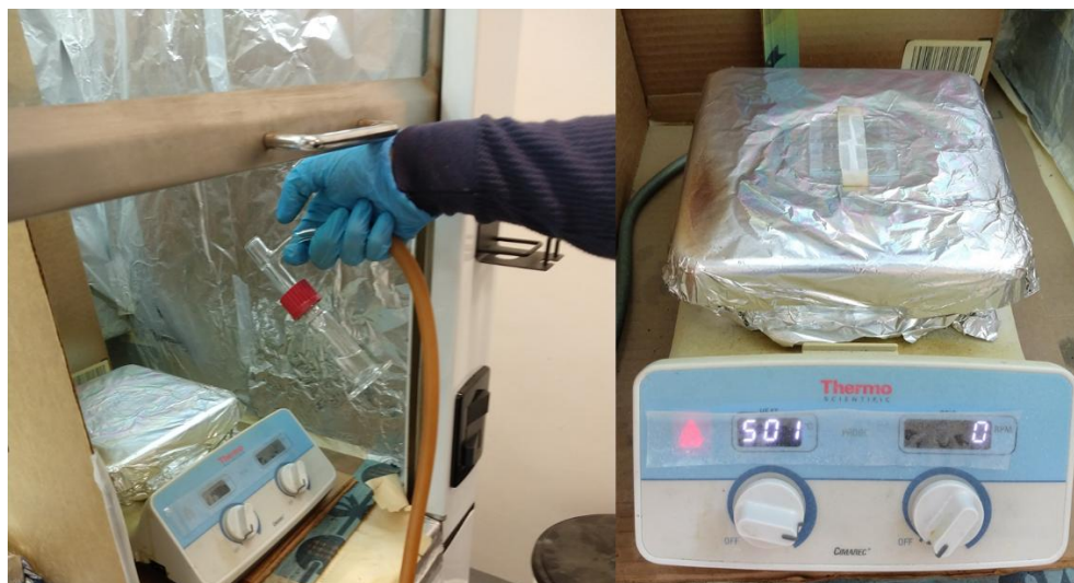
Figura 0.8. Deposición de la capa compacta de \text{TiO}_2 por spray pirolisis para su posterior calcinación a 500^\circ\text{C} .
