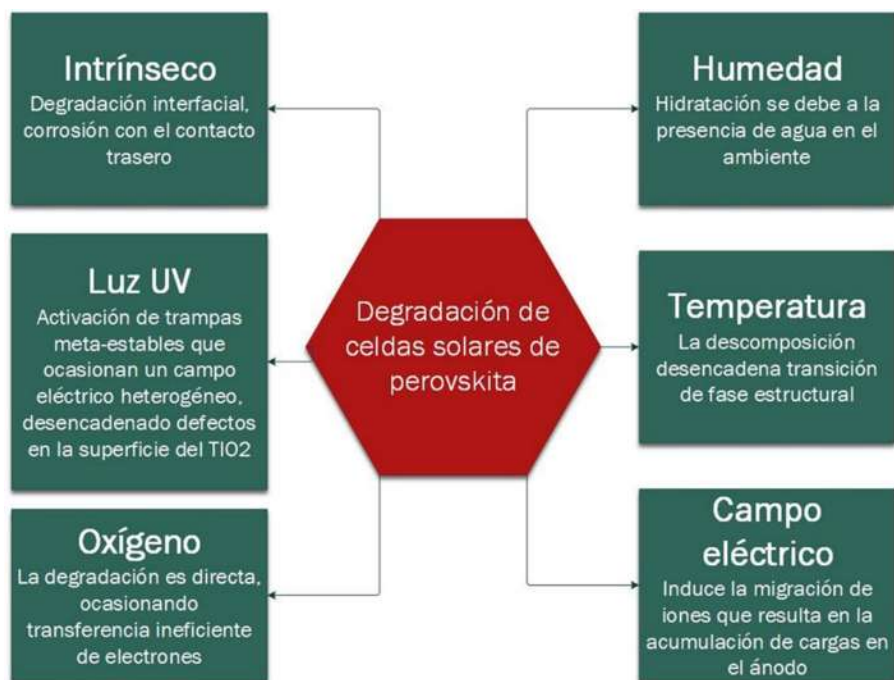
Figura 0.13. Esquema de la degradación de celdas solares de perovskita por varios factores [71, 162].
