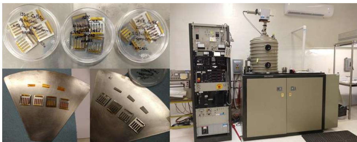
Figura 0.12. Evaporadora utilizada para el depósito del contraelectrodo de aluminio.
