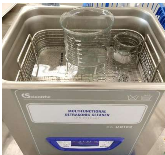
Figura 0.7. Proceso de lavado de los vidrios de FTO, empleando un baño en ultrasonido.
