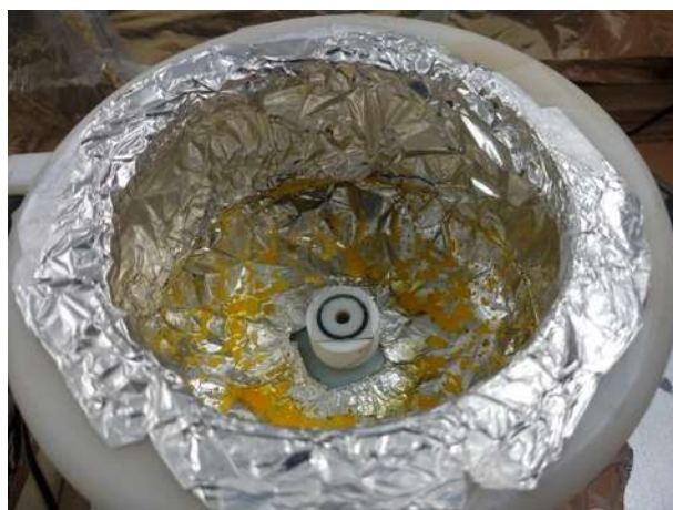
Figura 0.10. Depósito de los puntos cuánticos de \text{CsPbBr}_3 por spin-coating
