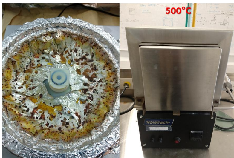
Figura 0.9. Deposición de la pasta de \text{TiO}_2 18NR-T por spin-coating y tratamiento térmico de las muestras con el depósito de \text{TiO}_2 .
