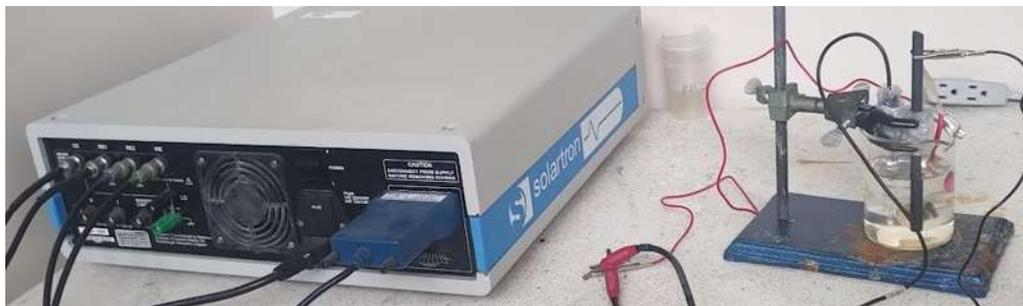
**Figura 3.6.** Celda de tres electrodos conectada a equipo potenciostato/galvanostato.
