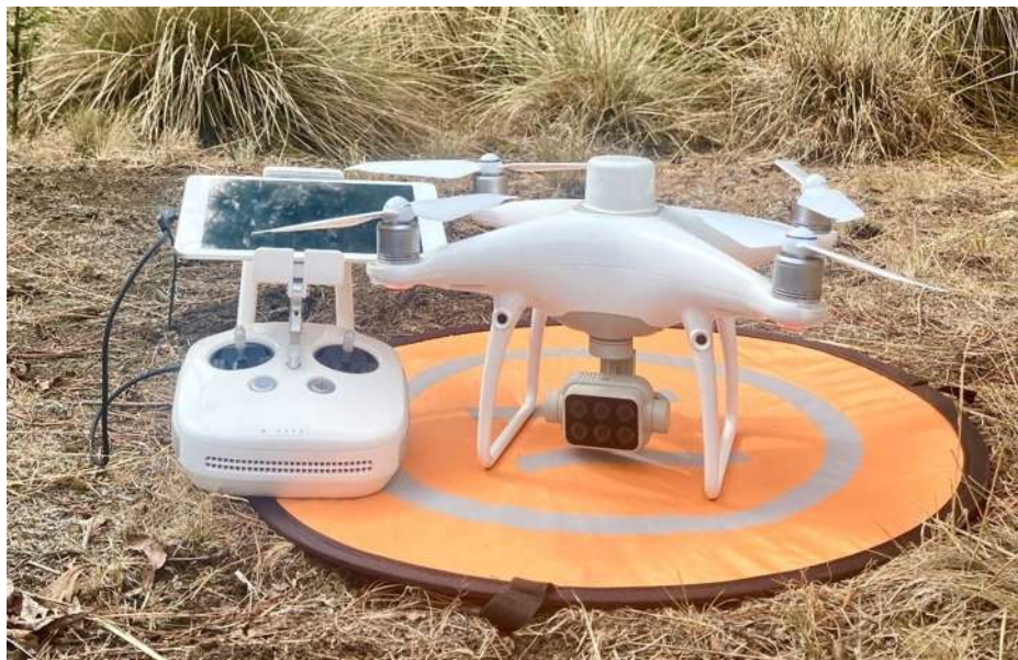
Figura 2. DJI Phantom 4 Multispectral utilizado para la adquisición de las imágenes, junto al control remoto y dispositivo móvil (iPad) para visualizar la App de vuelo Ground Station Pro.
