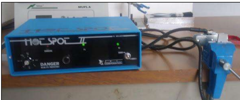
Figura 3-15 Equipo DDC Hot Spot Thermocouple Welder
