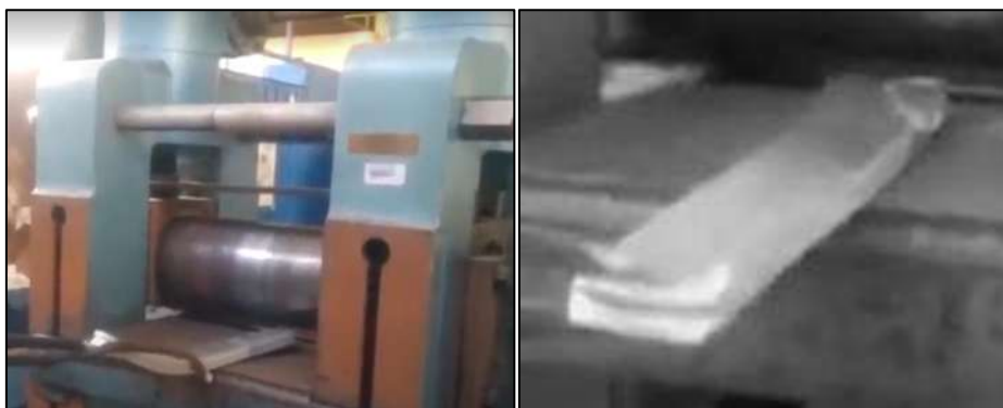
Figura 4-4 Lingote después de ser laminado hasta obtener un espesor de 13 mm de una aleación base Zn-Al-Ag.
