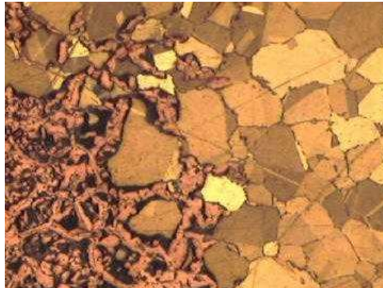
Figura 2-16 Ejemplo de la descincificación del latón [40].
