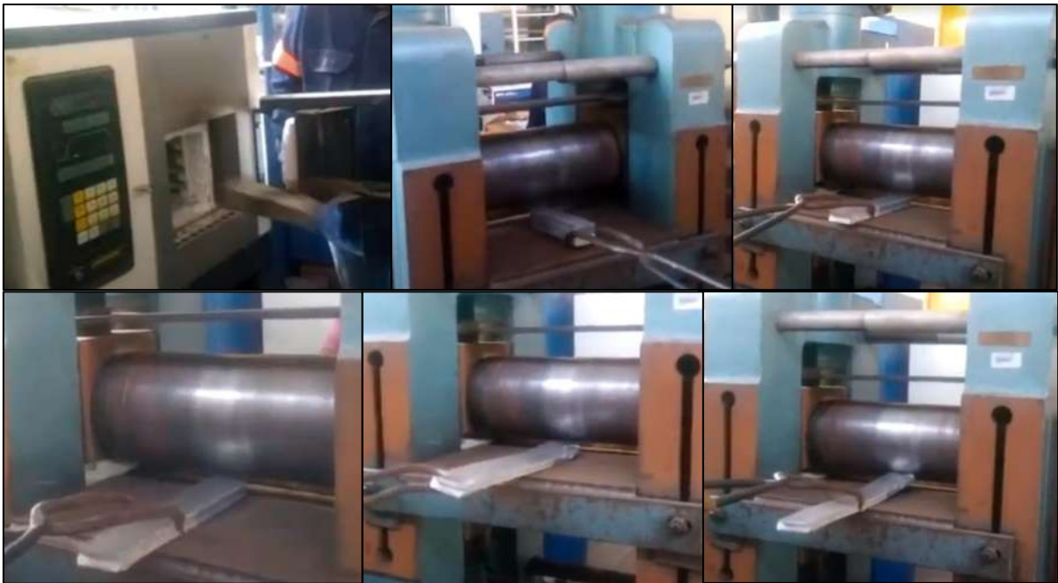
Figura 3-7 Proceso de laminación de una aleación Zn-Al-Ag (4%W) de dimensiones 45x45x153 mm.
