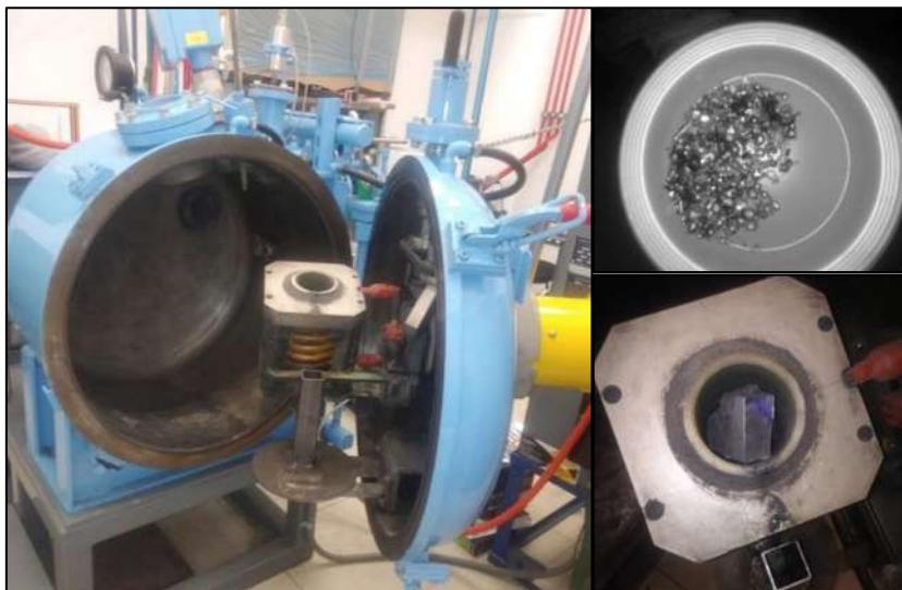
Figura 3-3 Horno de inducción al vacío, marca CONSARC, introducción de plata, aluminio y zinc.
