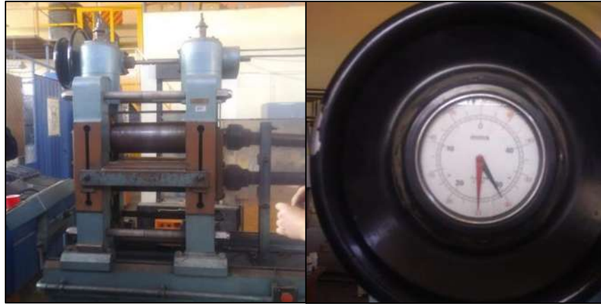
Figura 3-5 Equipo de laminación. Laboratorio del Instituto de Investigación en Metalurgia y Materiales. UMSNH
