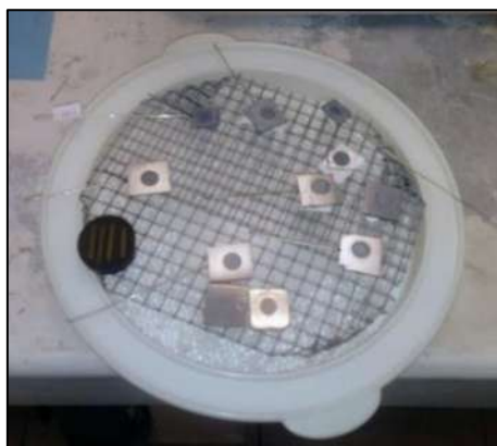
Figura 3-20 Probetas con productos de corrosión por diferentes soluciones y técnicas electroquímicas.
