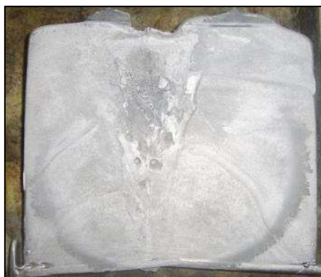
Figura 4-1 Lingote obtenido utilizando un horno de inducción de una aleación base Zn-Al-Ag.
