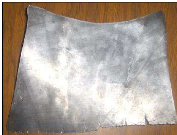
Figura 3-6 Sección de lingote de una aleación Zn-Al-Ag (4% en peso), laminado de 80mm a 2mm de espesor
