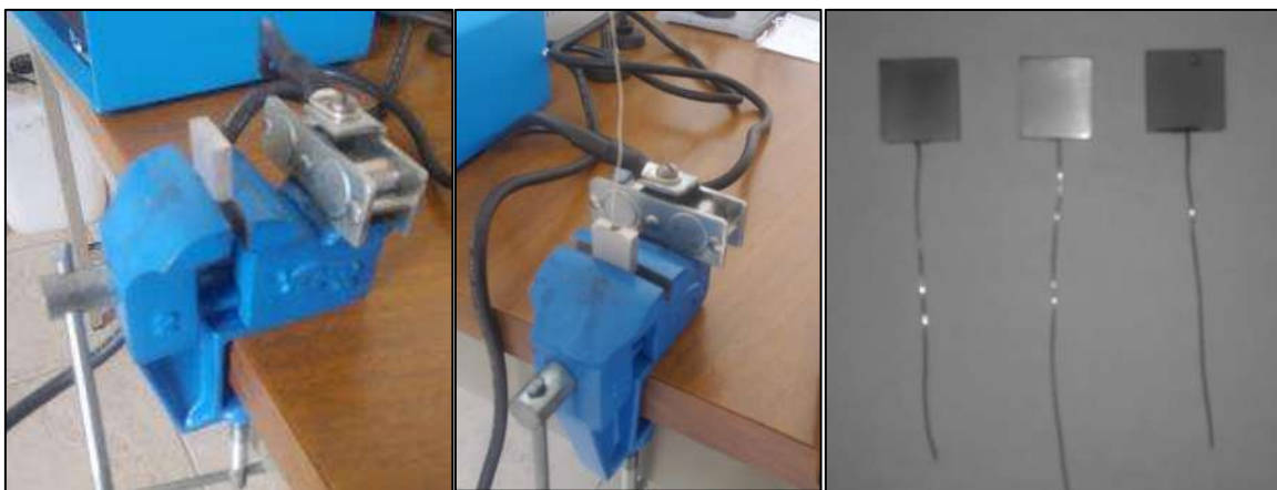
Figura 3-16 Procedimiento de soldadura de alambre a probetas de Zn-Al-Ag (4%w), para realizar pruebas electroquímicas, y probetas desbastadas (soldadas) para las evaluaciones electroquímicas.
