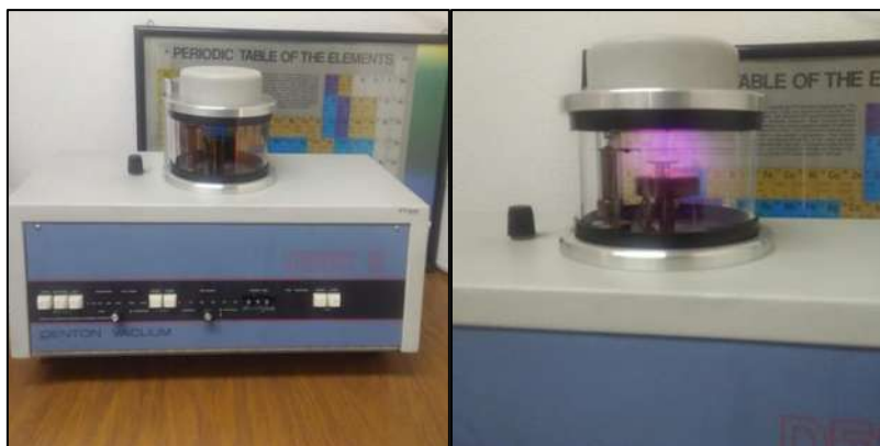
Figura 3-12 Denton Vacuum Desk II. Equipo para realizar sputtering . Posgrado en ciencias en Metalurgia. Tecnológico Nacional de México, Campus Morelia.
