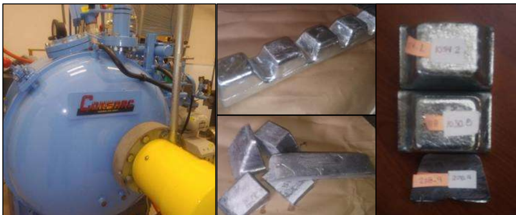
Figura 3-2 a) Horno de inducción al vacío, marca CONSARC. b) Corte de zinc y aluminio para fundición.
