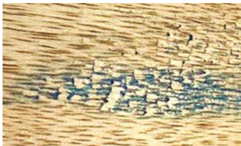
Figura 4. Ejemplo visual de grano astillado
