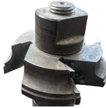
b) Fresa con pastilla de carburo de tungsteno
