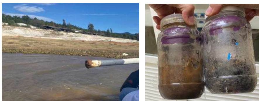
Figura 3.5.- Muestreo de sedimentos en la Presa de Cointzio. Fuente: Elaboración propia.
