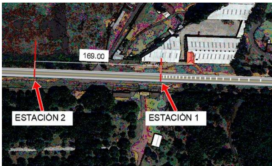
Figura 3-13. Carretera MEX-037 “Carapan – Playa Azul”, tramo “Carapan – Uruapan”, km 58+600, marca vial “Rayas con Espaciamiento Logarítmico” colocada extremo aguas abajo a partir de la estación 1.
