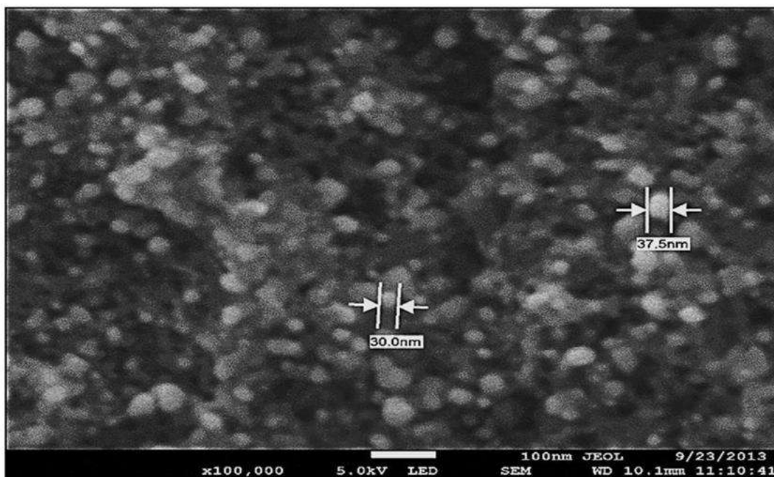
Figura 2.22. Imagen SEM de nanopartículas de plata (AgNPs) sintetizadas tratando extracto de Padina sp. con 0,01 M de solución de nitrato de plata [85]
