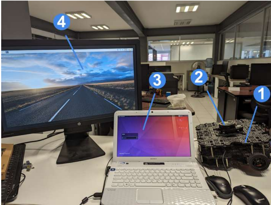
Figura 4.11: Model Kit utilizado de un robot móvil diferencial junto a los periféricos conectados.
