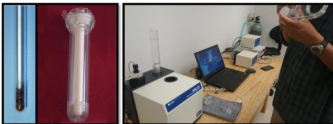
Figura 28. La muestra tamizada ubicada en el portamuestras (izquierda), y el dispositivo medidor de susceptibilidad MFK1-FA utilizado para generar las curvas termomagnéticas (derecha).
