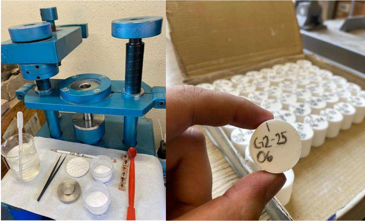
Figura 30. Preparación de capsulas de NaCl con especímenes orientados para estudios de paleointensidad.
