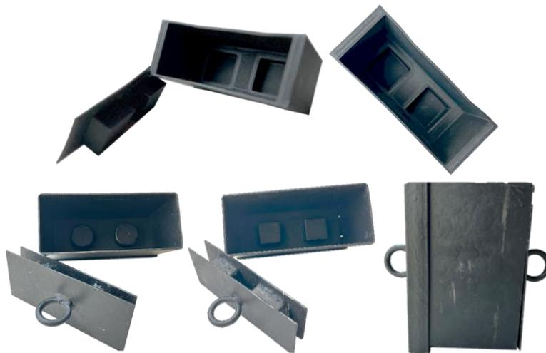
Ilustración 42. Moldes de plástico impreso y de acero fabricados. Elaboración propia.
