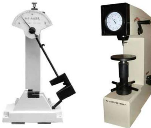
Ilustración 19. Medidor de impacto y de dureza respectivamente. Fuente: Imágenes de Google.
