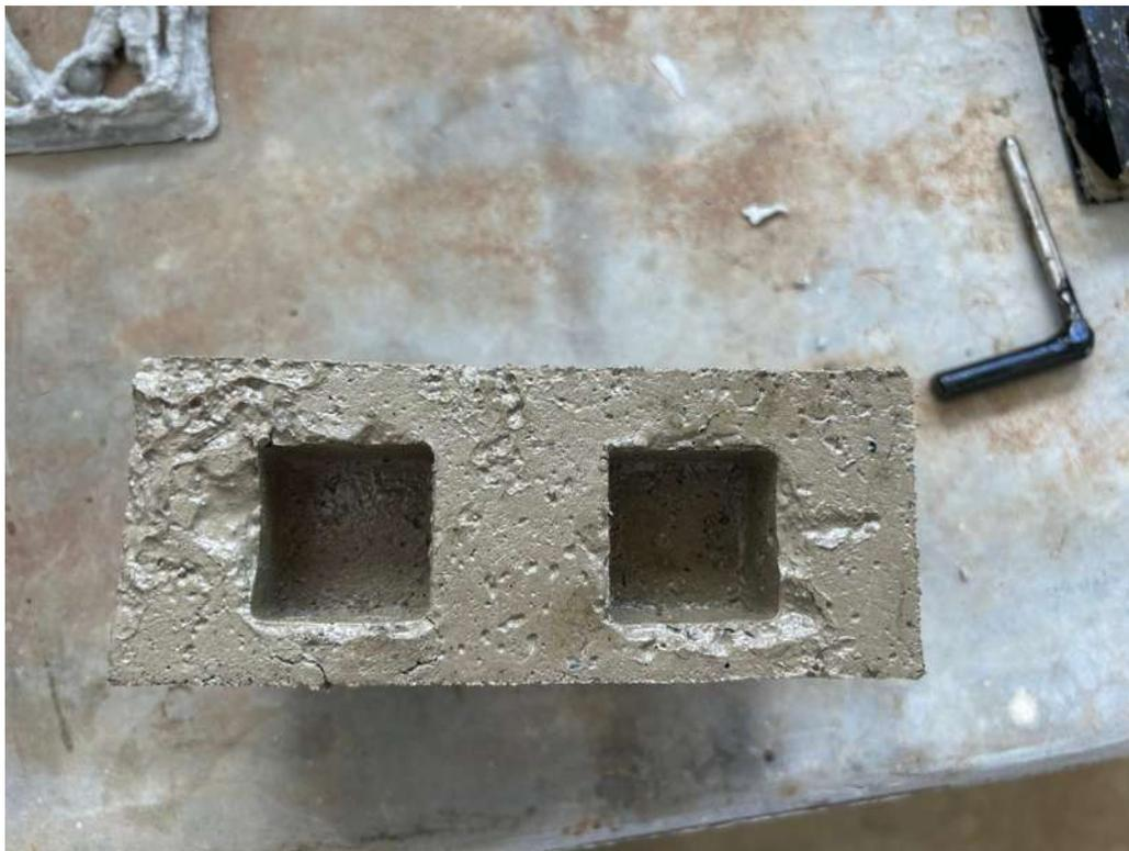
Ilustración 44. Resultados del uso de los moldes de plástico y acero. Elaboración propia.
