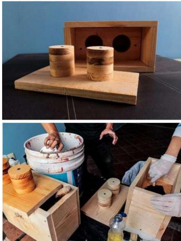
Ilustración 31. Fabricación de molde machihembrado. Elaboración propia.
