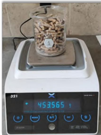
Figura 12. Evaluación de la densidad volumétrica mediante un volumen conocido.
