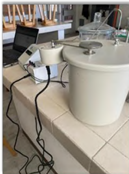
Figura 9. Bomba calorimétrica (Parr, 1108).
