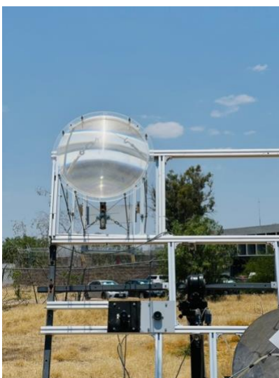
Figura 17. Sistema de concentración Fresnel montado al sistema de seguimiento solar.
