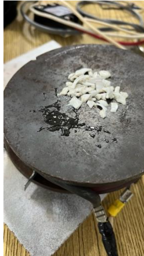
Figura 12. Fundición parcial del plástico.
