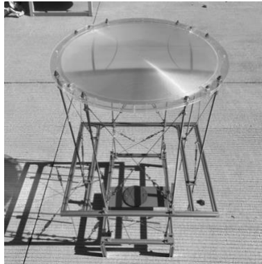
Figura 21. Sistema de concentración Fresnel y disco de acero para pruebas de temperatura.
