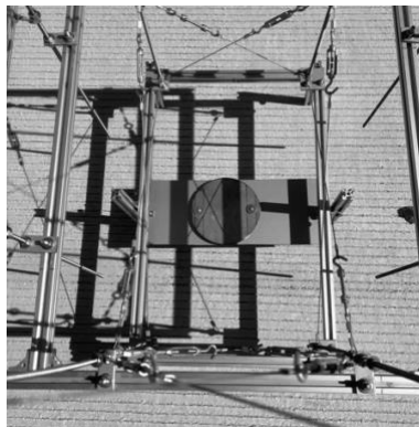
Figura 20. Acoplamiento de disco de acero a base para pruebas.
