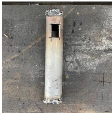
Figura 15. Tubo soldado en laterales con apertura.
