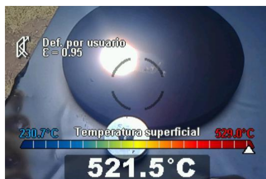
Figura 28. Temperatura máxima del disco de acero con recubrimiento.
