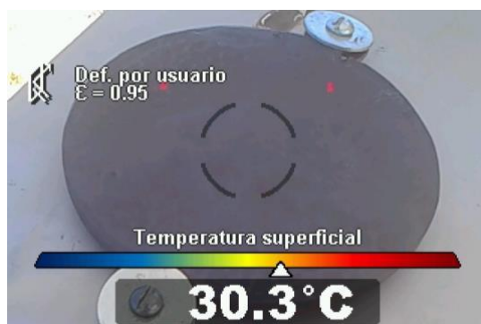
Figura 27. Temperatura inicial del disco de acero con recubrimiento.
