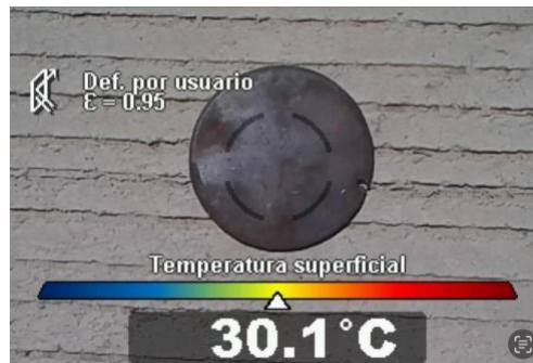
Figura 23. Temperatura inicial del disco de acero sin recubrimiento.
