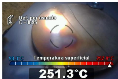
Figura 24. Máxima temperatura del disco de acero sin recubrimiento.
