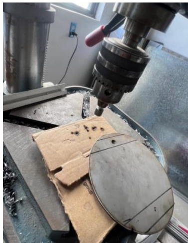
Figura 19. Perforaciones a disco de acero.
