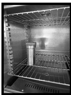
Figura 16: Reactor hidrotérmico dentro de la estufa de secado la cual se mantuvo a 200 °C.
