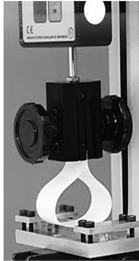
Figura 2. 11. Medidor de la dureza inmediata de un adhesivo.
