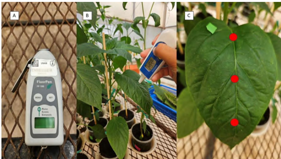
Figura 7. Determinación del rendimiento fotosintético y temperatura foliar en plantas de chile pasilla: A) Fluorómetro utilizado para las mediciones, B) Termómetro y medición de temperatura foliar, C) Hoja marcada para la medición de temperatura foliar y puntos en los que se realizó la medición.
