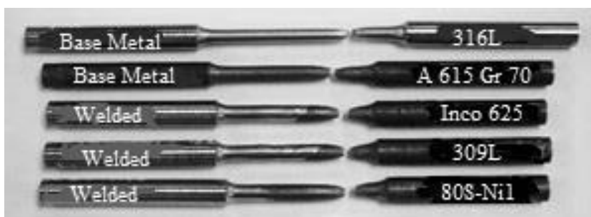
Figura 2.8 Fotografía de las probetas fracturadas de metales base y juntas soldadas [6].
