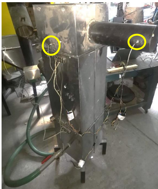
Figura 40.- Termopares conectadas en el cabezal y salida de Syngas
