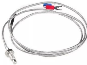
Figura 23.- Termopar o Termocupla tipo K (TECHNOLOGY, Mercado Libre, 2023)
