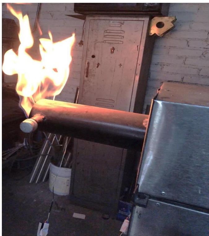
Figura 63.- Combustión sostenida en la salida de gas del gasificador
