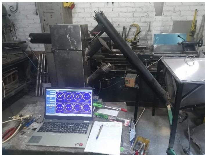
Figura 42.- Equipo de cómputo conectado al gasificador para realizar el monitoreo
