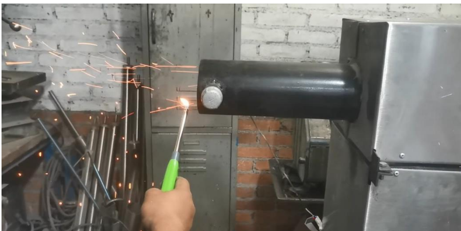
Figura 61.- Intento de combustionar el metano presente en el gas de síntesis en el precalentamiento del gasificador.
