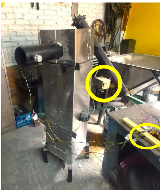
Figura 41.- Instalación de pirómetro y conexión de termopares con la tarjeta Arduino Mega
