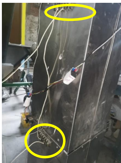
Figura 39.- Termopar y resistencias conectadas en el cenicero y cámara de combustión
