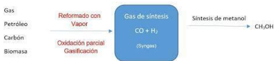
Figura 2.- Diagrama teórico de la obtención de Metanol
