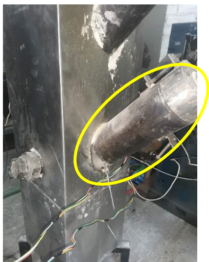
Figura 48.- Entrada de alimentación para la cámara de combustión del gasificador
