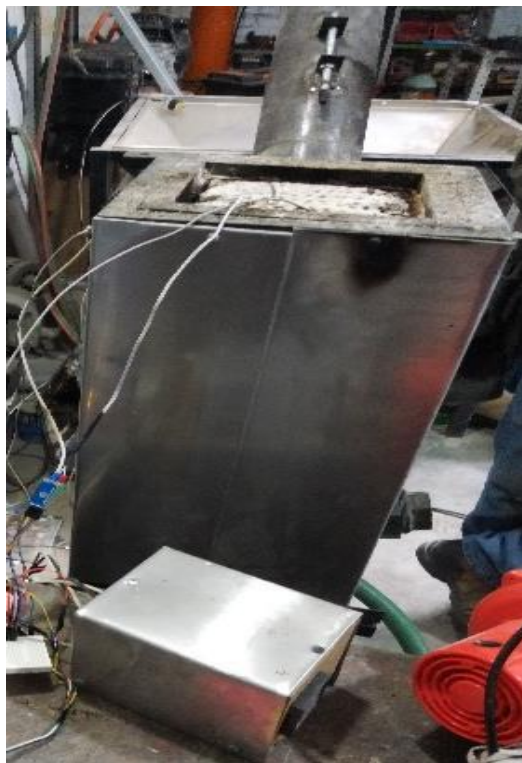
Figura 27.- Gasificador en proceso de armado para mostrar que es modular
