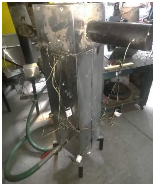
Figura 37.- Gasificador armado con sus tres módulos de flujo ascendente
