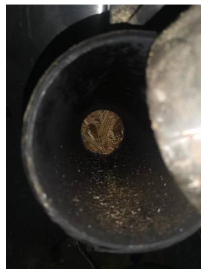
Figura 49.- Vista superior de la entrada de alimentación donde se puede observar el material dentro de la cámara ya precalentada
