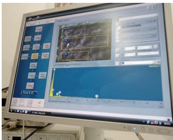
Figura 11. Evaluación SEM-EDS sobre las muestras
