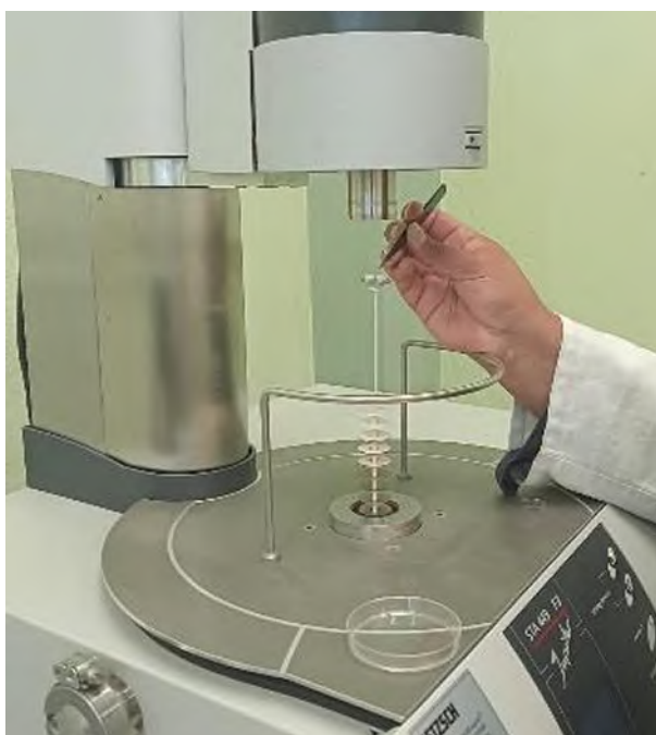
Figura 12. Preparación de las muestras para comenzar el ensayo DSC/TGA
