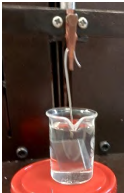
Figura 13. Aplicación de la película anticorrosiva en el sustrato
