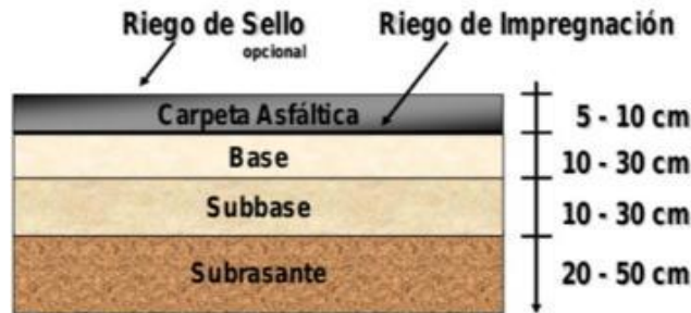
Ilustración 6. Capas de un pavimento flexible. (Villaroel, 2016)
