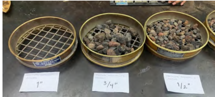
Ilustración 36. Material en cada malla para realizarle la prueba de partículas alargadas y lajeadas
