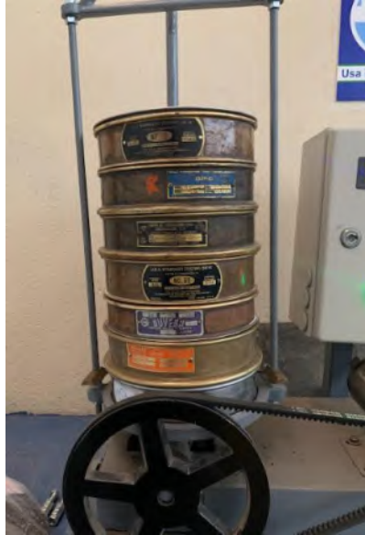
Ilustración 33. Equipo de cribado mecánico del laboratorio.
