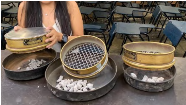
Ilustración 32. Cribado manual de agregados gruesos
