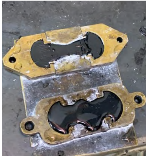
Ilustración 24. Preparación del asfalto en los moldes para probar.
