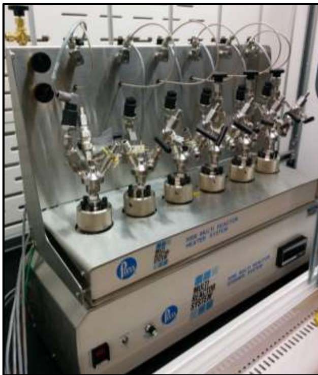
Figura 3.2 Sistema Parr modelo 5000 Multi Reactor Heater System utilizado para la realización de las pruebas catalíticas en modo batch.
