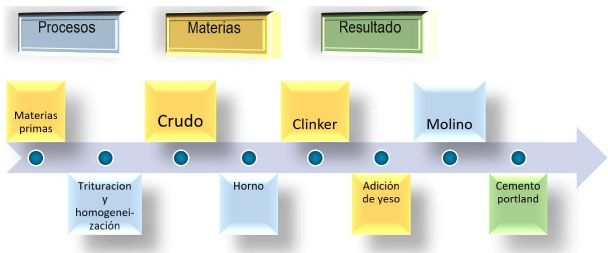
Ilustración 4: Esquema general de la fabricación del cemento [8].
