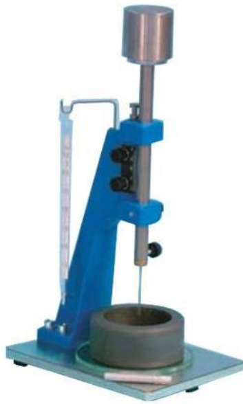
Ilustración 5: Aparato Vicat, determinación de la consistencia del cemento y del tiempo de fraguado. El instrumento consiste en una estructura metálica, escala graduada con índice, una sonda deslizante de 300 g, émbolo para medir la consistencia de 10 mm de diámetro, placa de vidrio [12].
