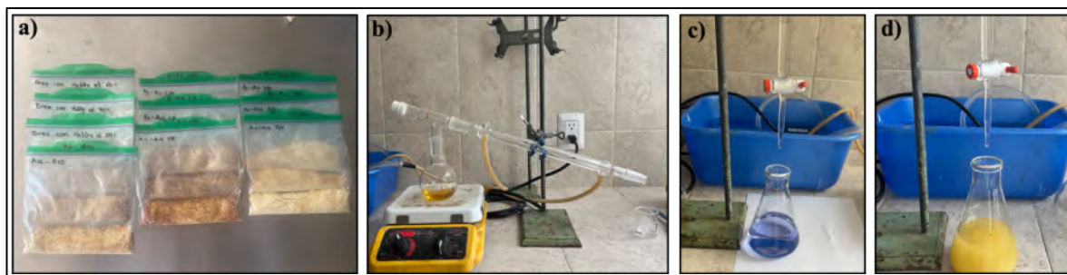
Figura 14. Procedimiento para prueba de saponificación, a) muestras de brea triturada, b) reflujo de la muestra con la solución alcalina, c) muestra con indicador de color, d) muestra titulada.
