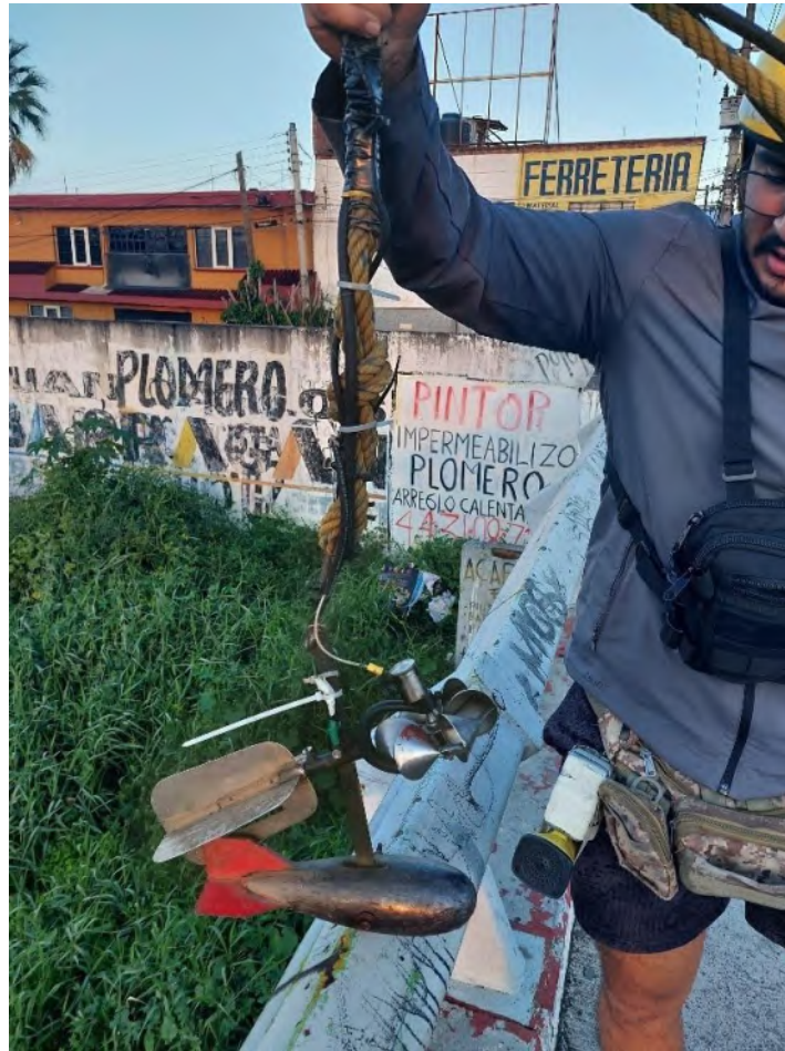
Figura 18 Molinete hidrométrico de estación "Av. Michoacán" Morelia.
