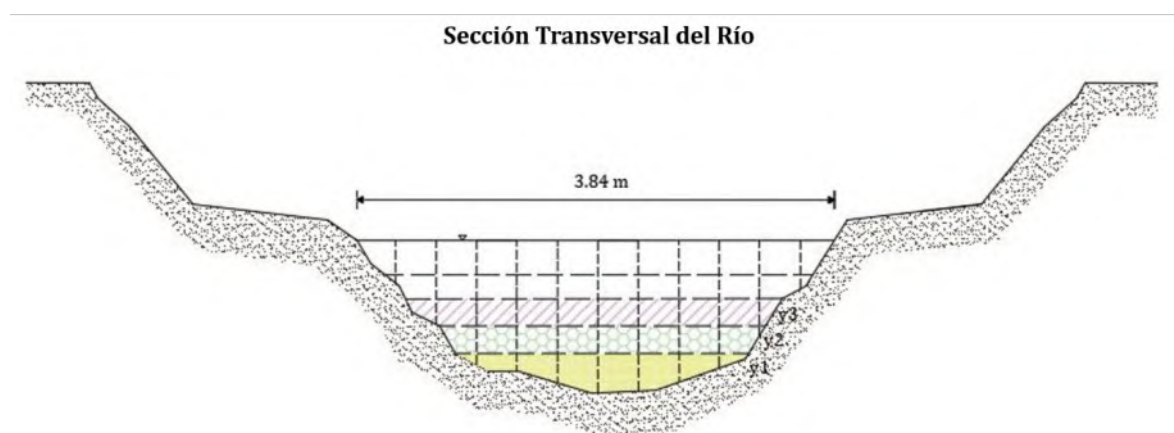
Figura 57. Método de dovelas para la generación de curvas de calibración
