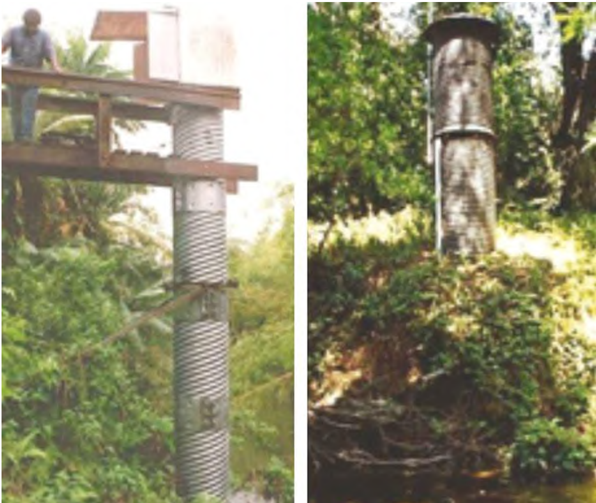
Figura 12 Amortiguador de acero corrugado y galvanizado (WMO, 2010)
