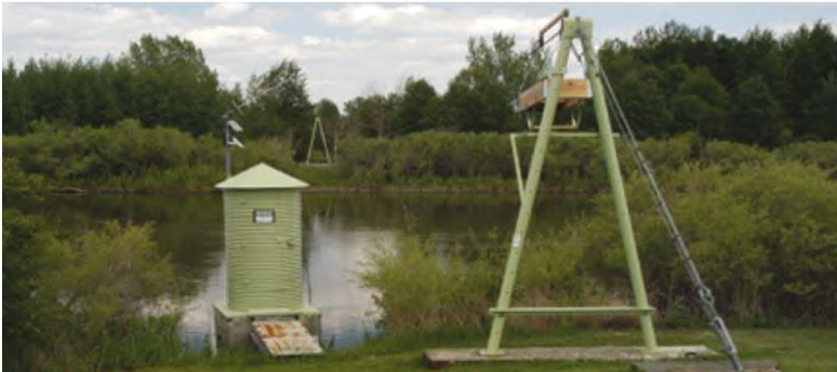
Figura 4 Medidor con caseta, paneles solares, antena satelital y medidor de peso de alambre en el puente (WMO, 2010)
