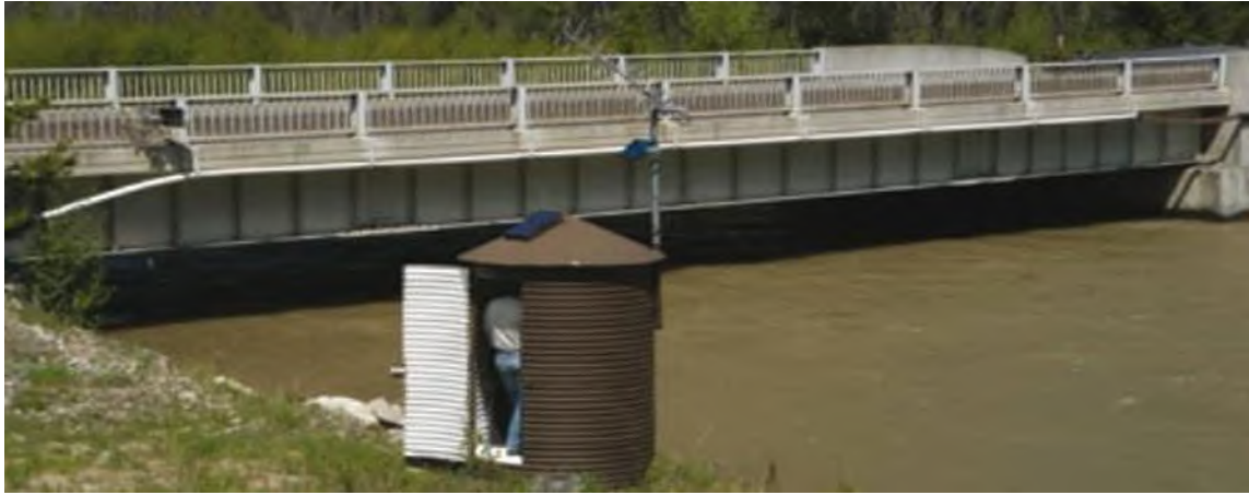
Figura 4 Medidor con caseta, paneles solares, antena satelital y medidor de peso de alambre en el puente (WMO, 2010)
