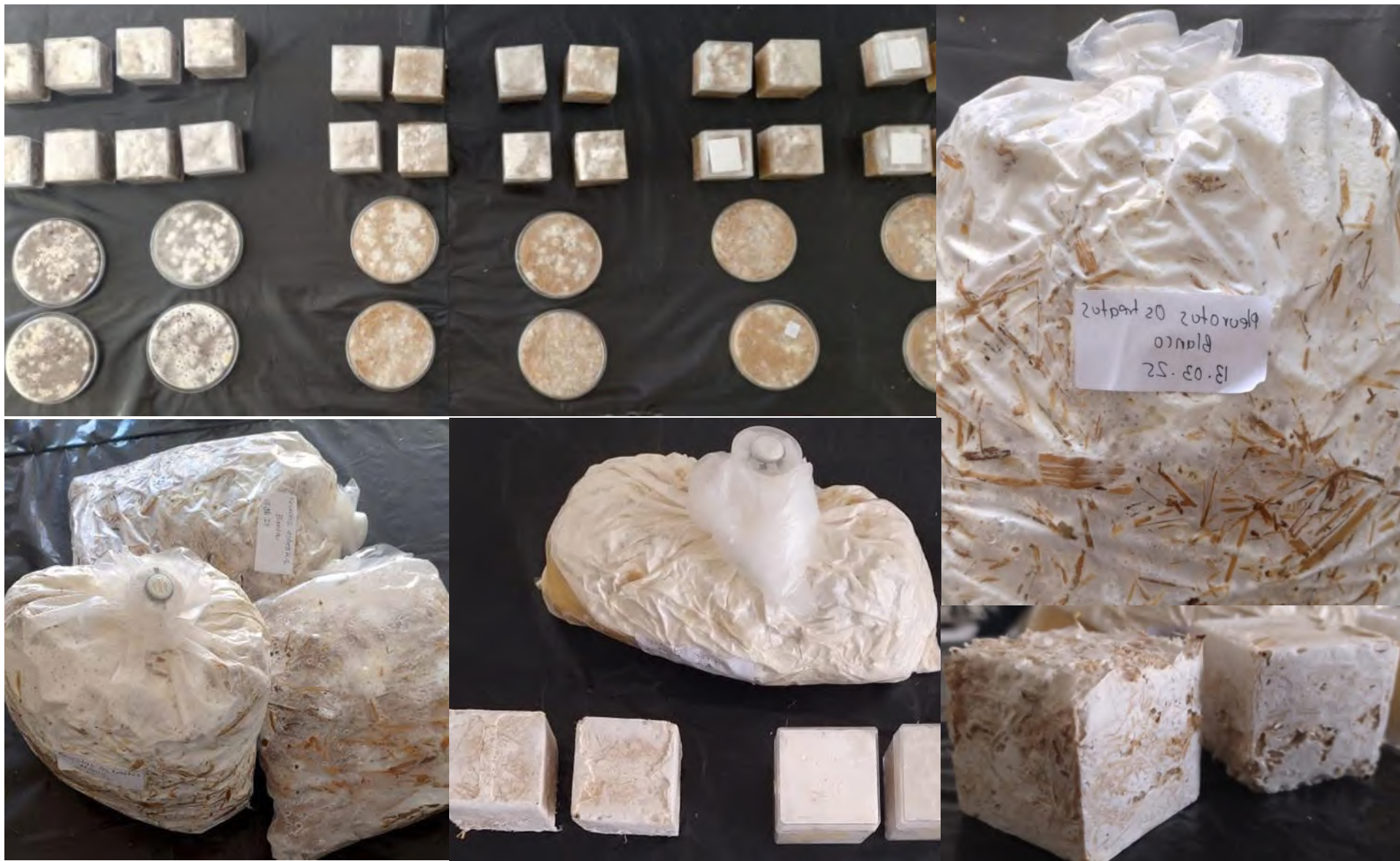
Figura 73. Diseño experimental herramientas área de trabajo, especímenes, placas, cubos y bolsa y zona de incubación oscura Fuente: registro fotográfico Autoría propia
