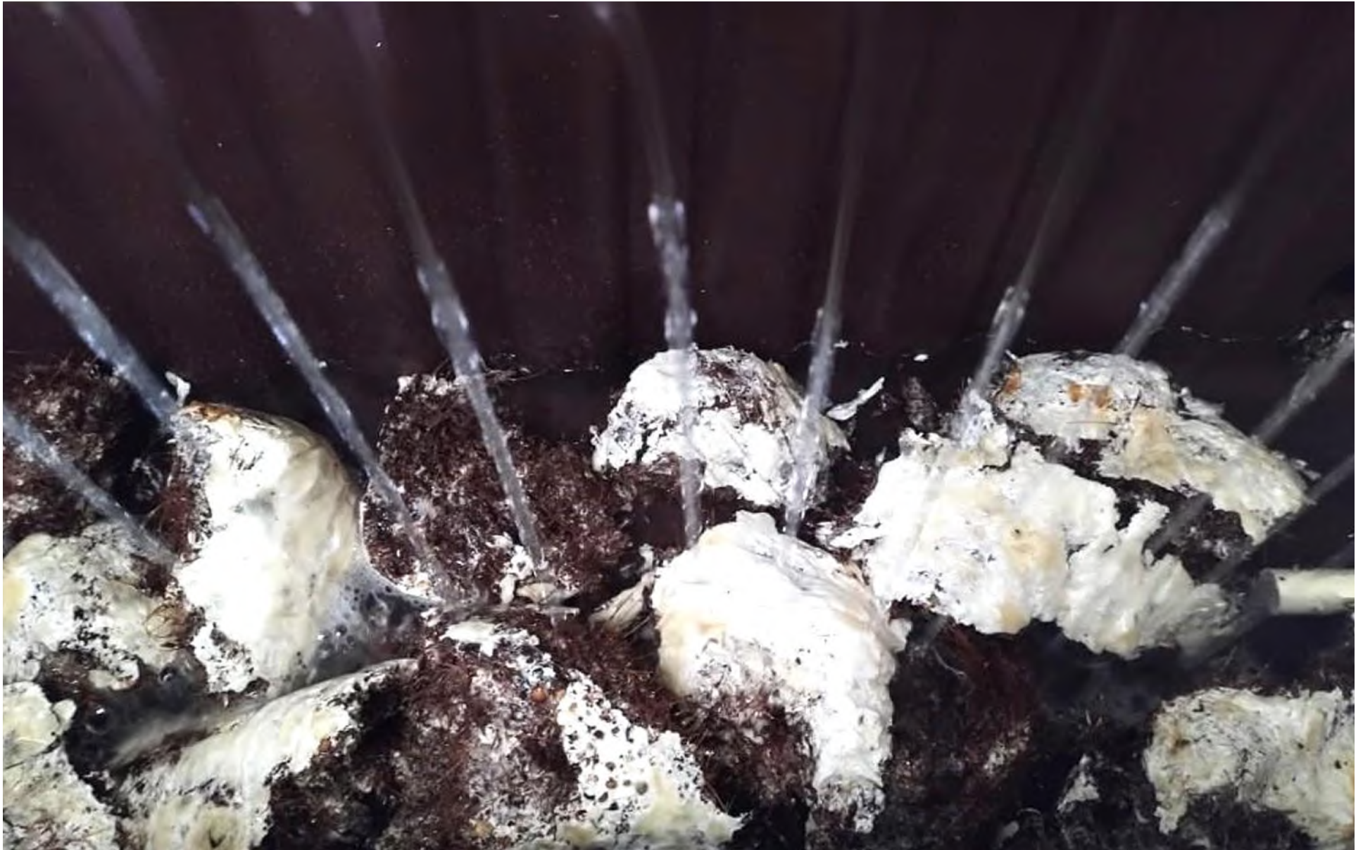
Figura 90. Proceso de filtración de microcosmo de Coco con el sistema de riego construido
