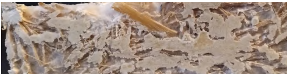
Figura 87. Registro fotográfico del biomaterial de Micelio Pleurotus Gris con fibra de trigo en molde de acrílico de más de 30 días de edad
