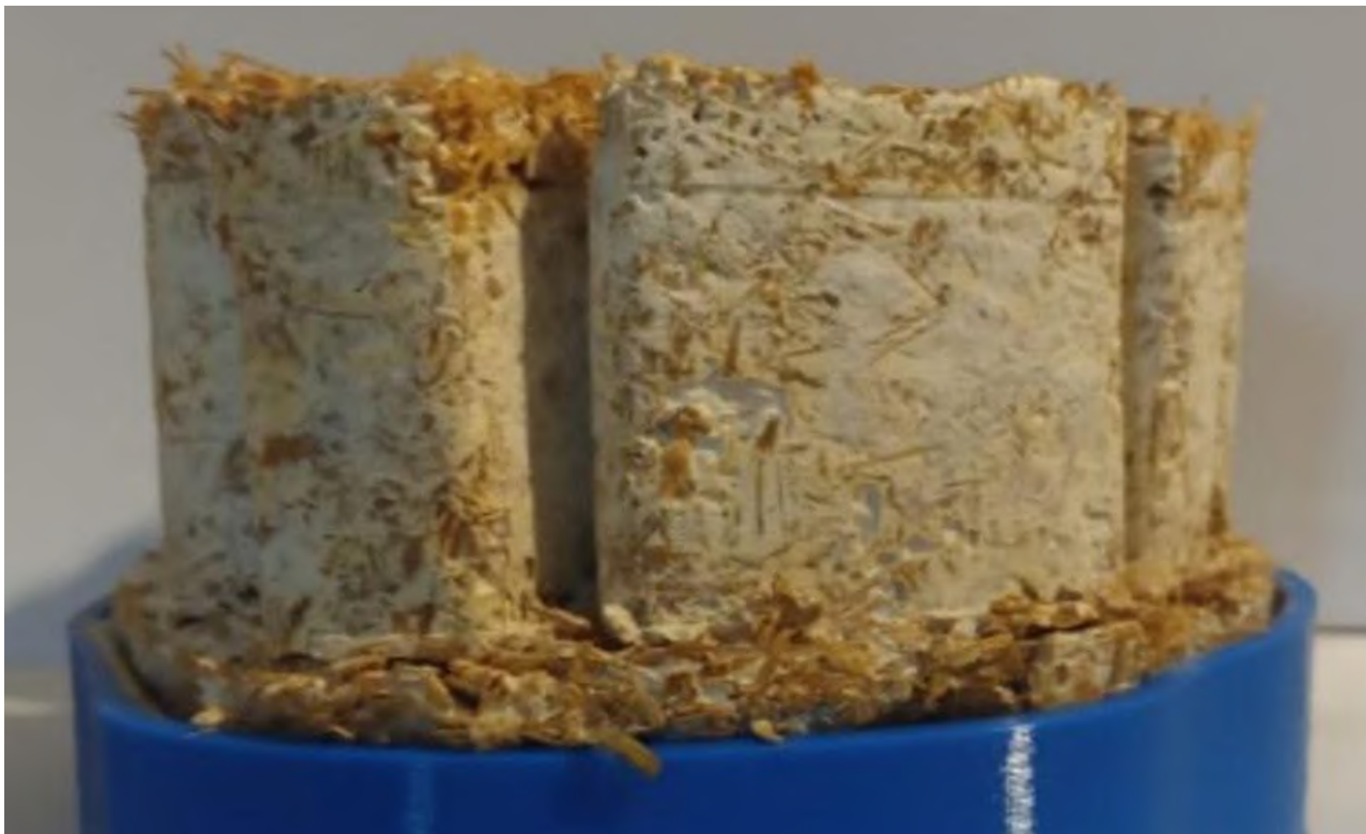
Figura 79. Prototipo de micelio de pleurotus ostreatus en fibra de trigo Septiembre de 2024
