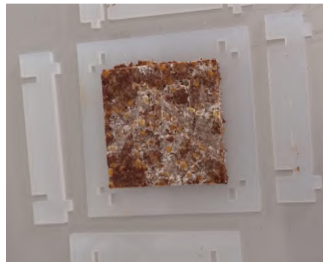
Figura 69. Moldes acrílicos placas de 1 cm
