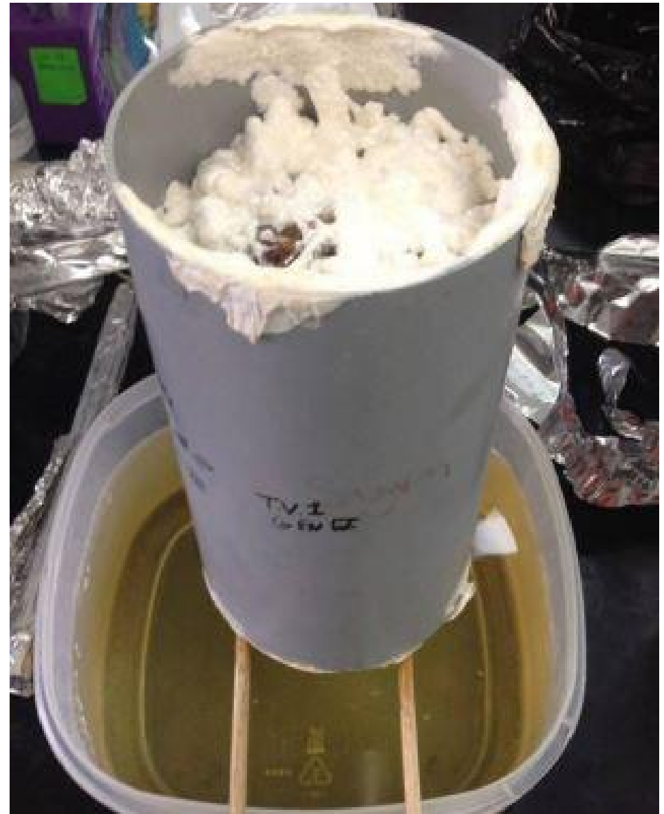
Figura 17. Biofiltro Ganoderma , filtrado del agua, Ecuador
