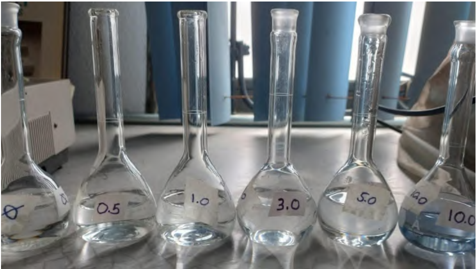
Figura 52. Solución estándar curva de calibración fósforo total
