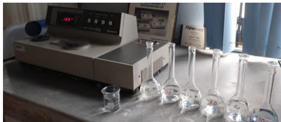
Figura 48. Pruebas de condiciones de agua, Espectroscopia UV-visible
