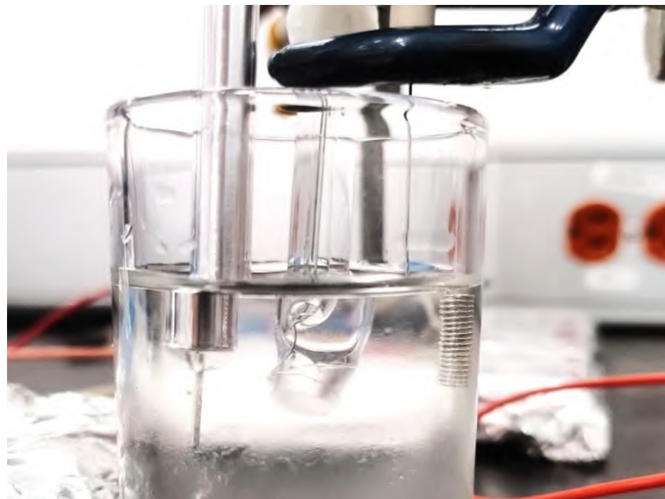
Figura 47. Pruebas de resistencia de Impedancia Electroquímica
