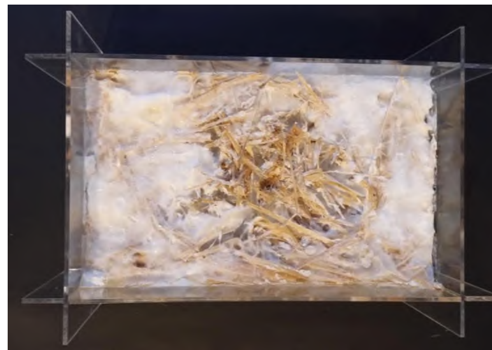
Figura 87. Registro fotográfico del biomaterial de Micelio Pleurotus Gris con fibra de trigo en molde de acrílico de más de 30 días de edad
