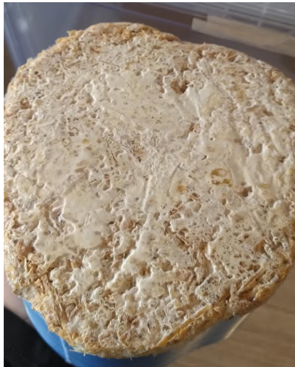
Figura 78. Moldes Prototipo de micelio de pleurotus ostreatus en fibra de trigo Septiembre de 2024
