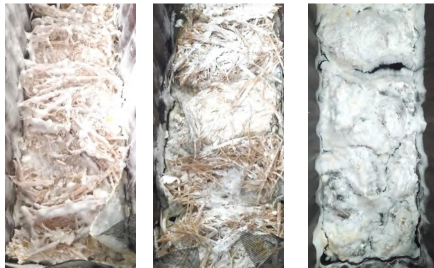
Figura 46. Registro fotográfico del Microcosmo para la filtración del agua con Micelio Pleurotus con fibra de trigo, avena y coco
