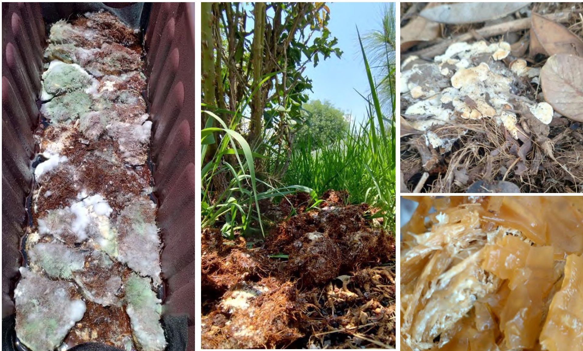
Figura 88. Registro fotográfico del biomaterial de Micelio Pleurotus Gris con fibra de coco en microcosmos plásticos, de más de 30 días de edad, con presencia de contaminantes y ciclo final en compostaje y zonas de jardín
