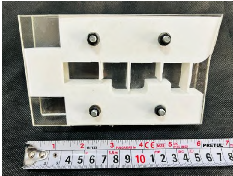
Figura 4.12 Modelo de impresión 3D con piezas de acrílico montadas para observar el flujo del humo trazador.
