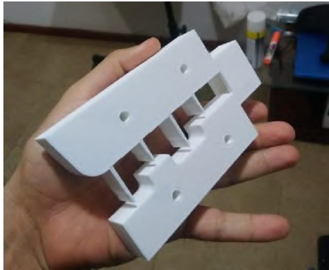
Figura 4.11 Pieza de impresión 3D del canal de flujo de vapor.
