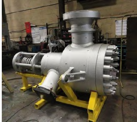
Figura 2.25 Válvula de control para turbina de vapor. (Alstom Data base n.d.).
