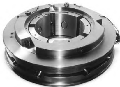
Figura 2.26 Cojinete radial para rotor de turbina.(Alstom Data base n.d.).
