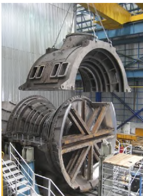
Figura 2.20 Carcasa para turbina de vapor. (Alstom Data base n.d.).
