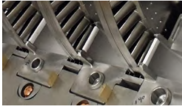
Figura 2.30 Sellos de vapor entre discos móviles del rotor de turbina. (Alstom Data base n.d.).
