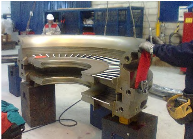
2.24 Diafragmas para turbina de acción. (Alstom Data base n.d.)
