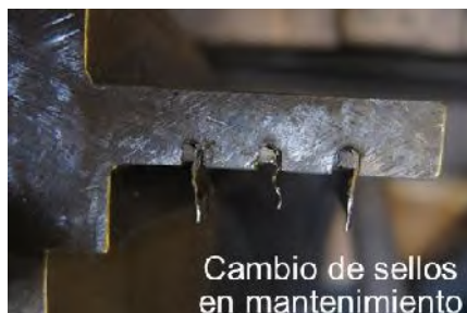
Figura 2.43 Laminillas de sello desgastadas.(Alstom Data base n.d.).
