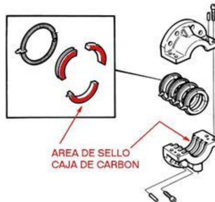
Figura 2.35 Caja de sellos de carbones para turbina.(Norton 2009).
