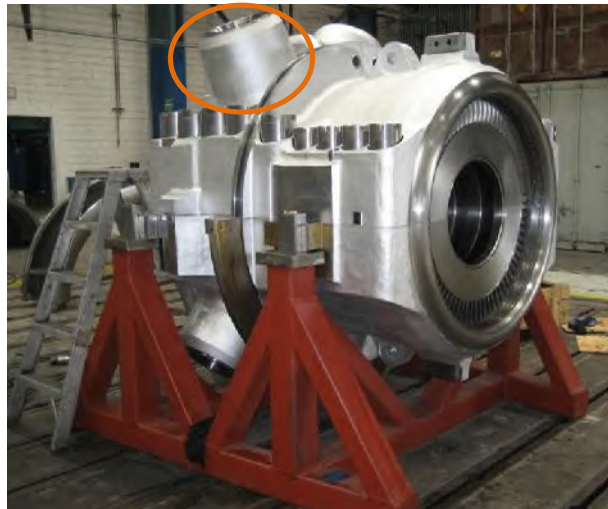
Figura 2.23 Carcasa para turbina de vapor donde se resalta en la parte superior la tobera. (Alstom Data base n.d.).
