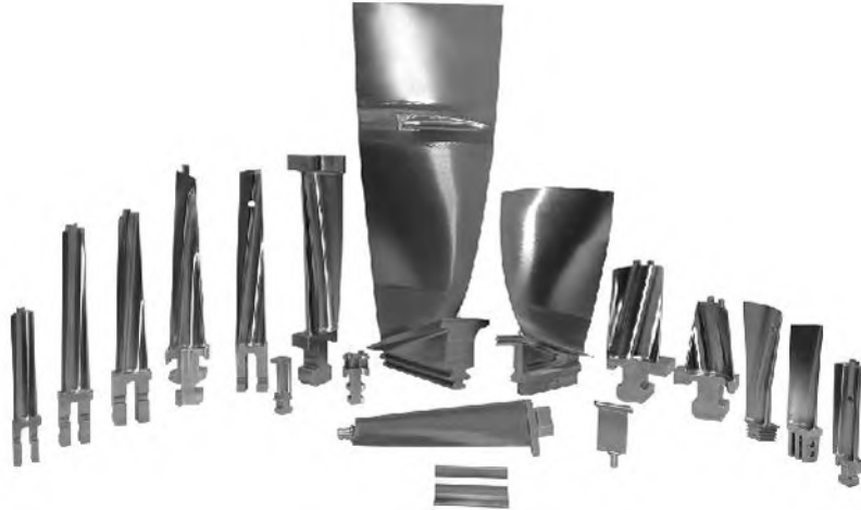
Figura 2.22 Alabes para turbina de vapor. (Alstom Data base n.d.).
