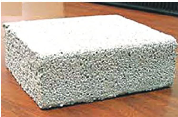
Fig. 26 Ladrillo ligero fabricado de espuma sintáctica [40]
