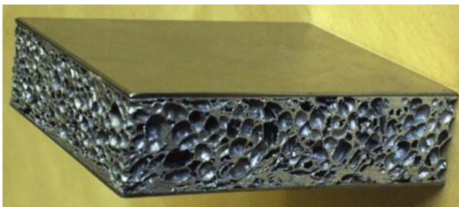
Fig. 10 Paneles sándwich basados en espumas metálicas.[40]
