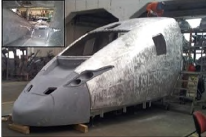
Fig. 11 Estructura de panel sándwich de espuma para prototipo de tren de alta velocidad.[38]
