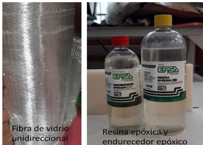
Figura 4.5. Fibra de vidrio y resina epóxica.
