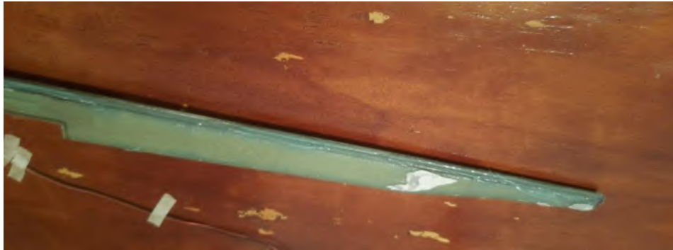
Figura 4.33. Detalle del adhesivo en la pieza terminada.
