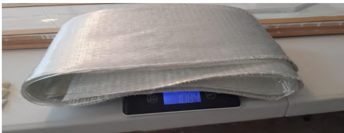
Figura 4.20. Pesaje de las capas de fibra de vidrio.
