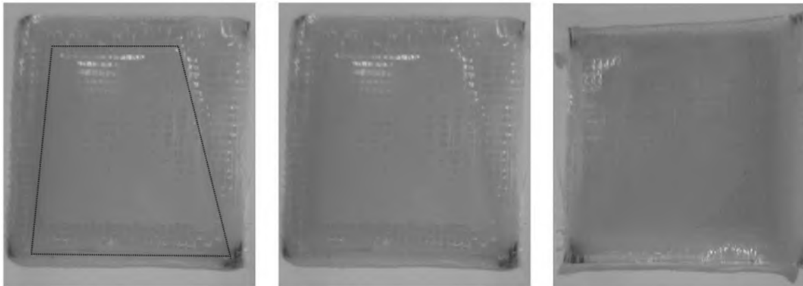
Figura 4.15. Fibra de vidrio infundida.
