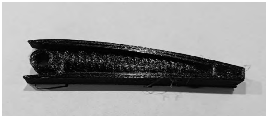
Figura 4.36. Prototipo seleccionado para el mecanismo FishBAC.
