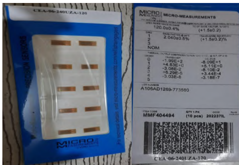
Figura 5.2. Galgas extensométricas CEA-06-24UZA-120.
