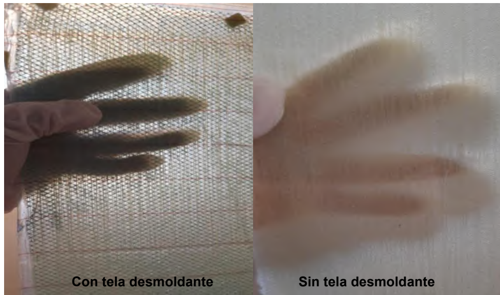
Figura 4.31. Pieza antes y después de retirar la tela desmoldante.
