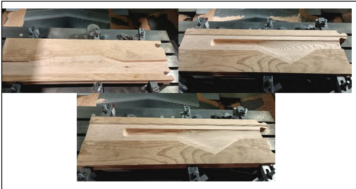
Figura 4.17. Manufactura de los moldes en centro de maquinado CNC.
