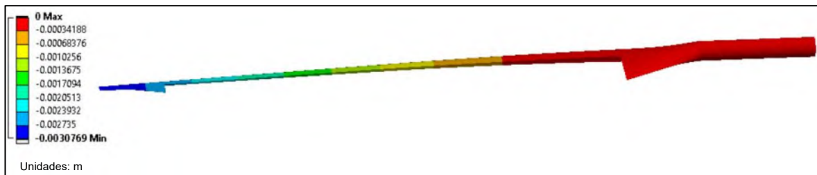
Figura 3.35. Desplazamiento direccional para Lead-lag (Hipótesis de carga F).
