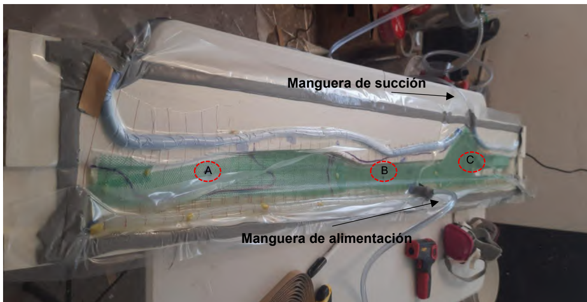
Figura 4.25. Infusión del molde del álabe
