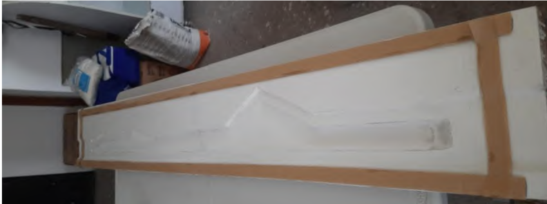
Figura 4.21. Aplicación de agentes desmoldantes.
