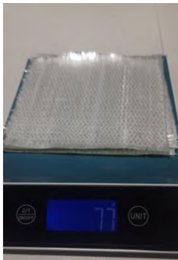
Figura 4.9. Pesaje de la fibra de vidrio unidireccional
