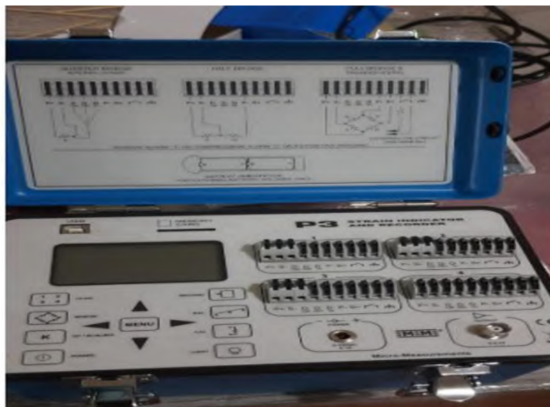
Figura 5.10. Indicador de tensión y registrador modelo P3.
