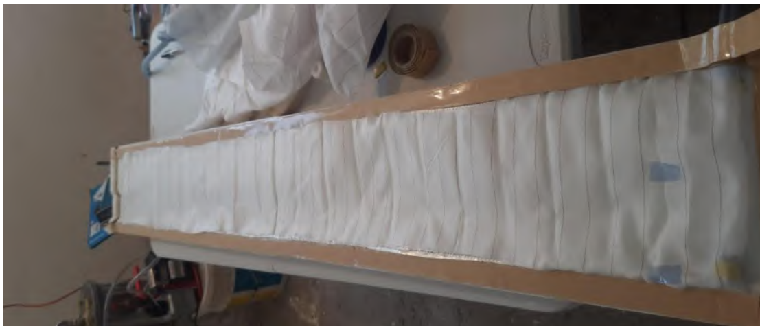
Figura 4.23. Colocación de la tela desmoldante.
