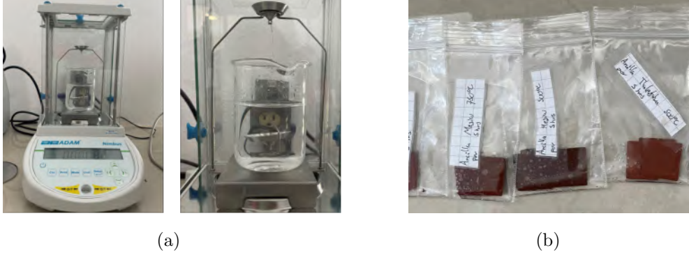
Figura 2.8: a) Sistema para medir la densidad, b) muestras sumergidas en agua por 48 horas.
