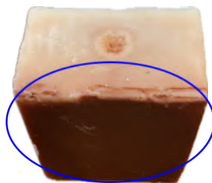
Figura 4.9: Sedimentación del polvo de arcilla en el compuesto.
