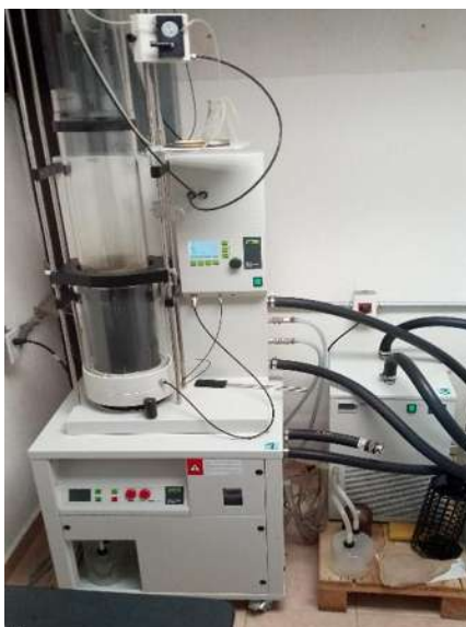
Figura 9. Secado del extracto acuoso en Nano spray dryer B 90. (Tomado de Alvarez, 2020).
