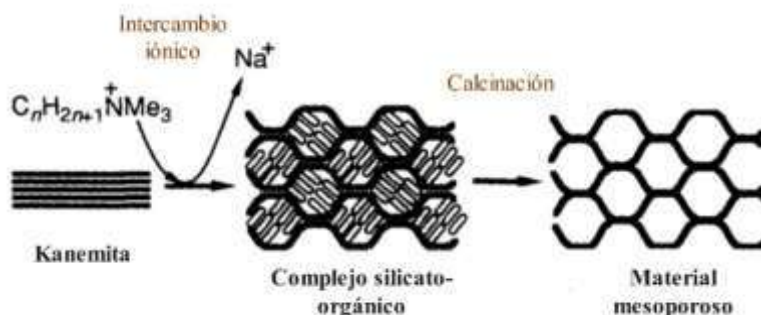
Figura 2.6 Modelo esquemático para la formación del material mesoporoso a partir de kanemita. Adaptado de (Inagaki et al., 1993).
