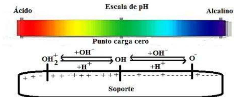
Figura 10. Esquema de equilibrio en la superficie en función del pH. El punto isoeléctrico es donde existe equilibrio de cargas en la superficie del soporte ("Influence of Titania Loading on Tungsten Adsorption," 1995).
