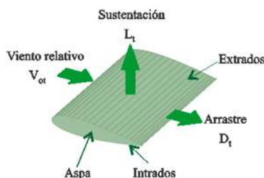
Figura 2-1: Fuerzas ejercidas sobre el aspa.
