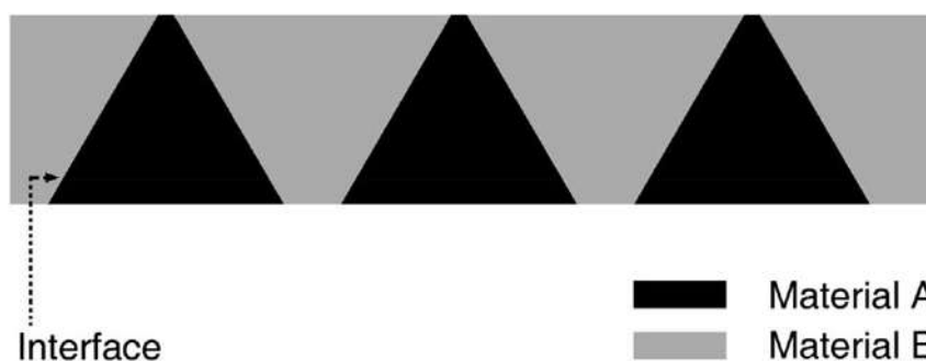
Figura 2.30. Diseño esquemático de rectificador térmico con dos diferentes materiales con forma cónica [76].
