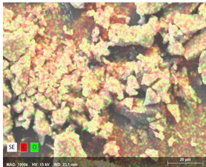
Figura 2.14. Micrografía de la mezcla resina/hollín al 30%, la cual muestra la presencia de carbono y oxígeno, así como una distribución homogénea de la mezcla [47].
