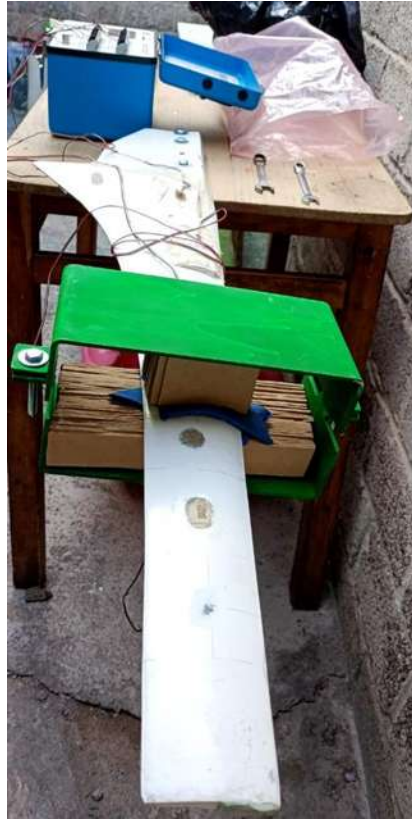
Figura 48. Vista frontal del módulo instalado en el aspa.
