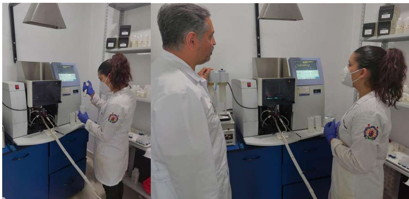
Figura 3. Medición de As mediante espectroscopía de absorción atómica (AAS).
