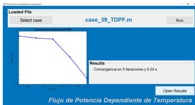
Figura A.1: Convergencia del sistema de Nueva Inglaterra de 39 nodos con compensación serie.
