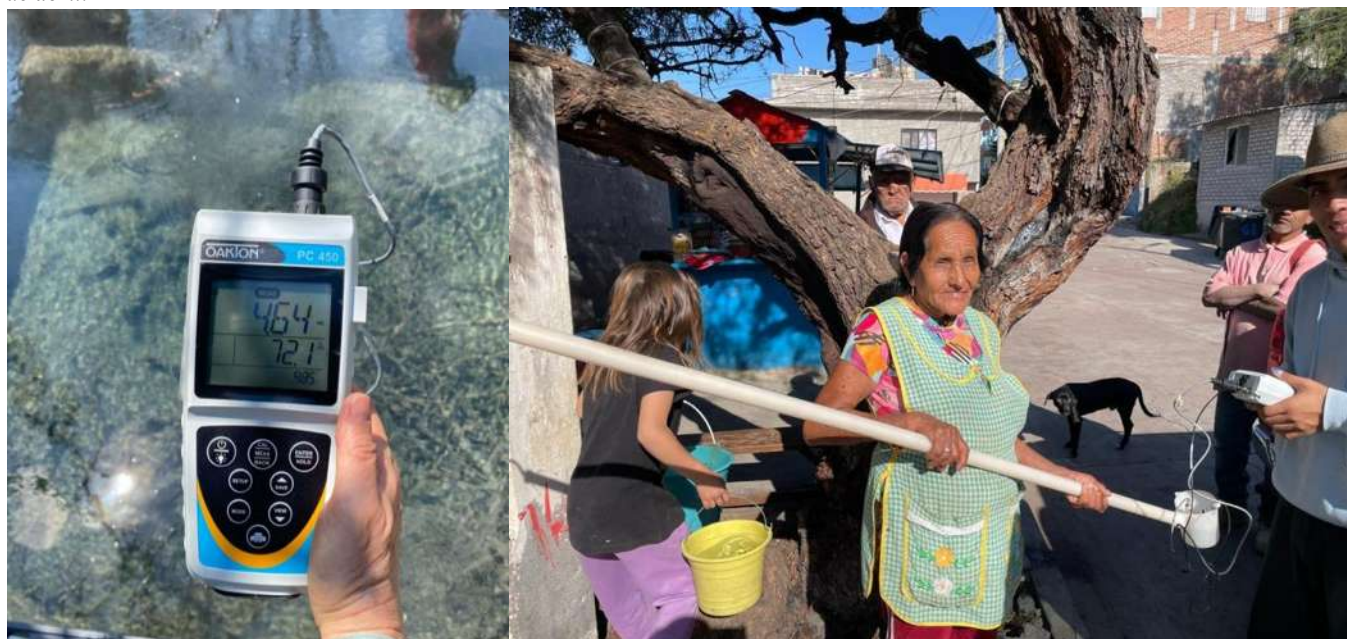
Figura 22. Multiparamétrico usado para la medición de los parámetros fisicoquímicos durante el primer muestreo correspondiente al mes de abril.
