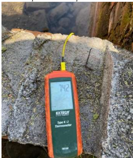
Figura 21. Termopar de doble entrada tipo K/J usado para medir temperatura.
