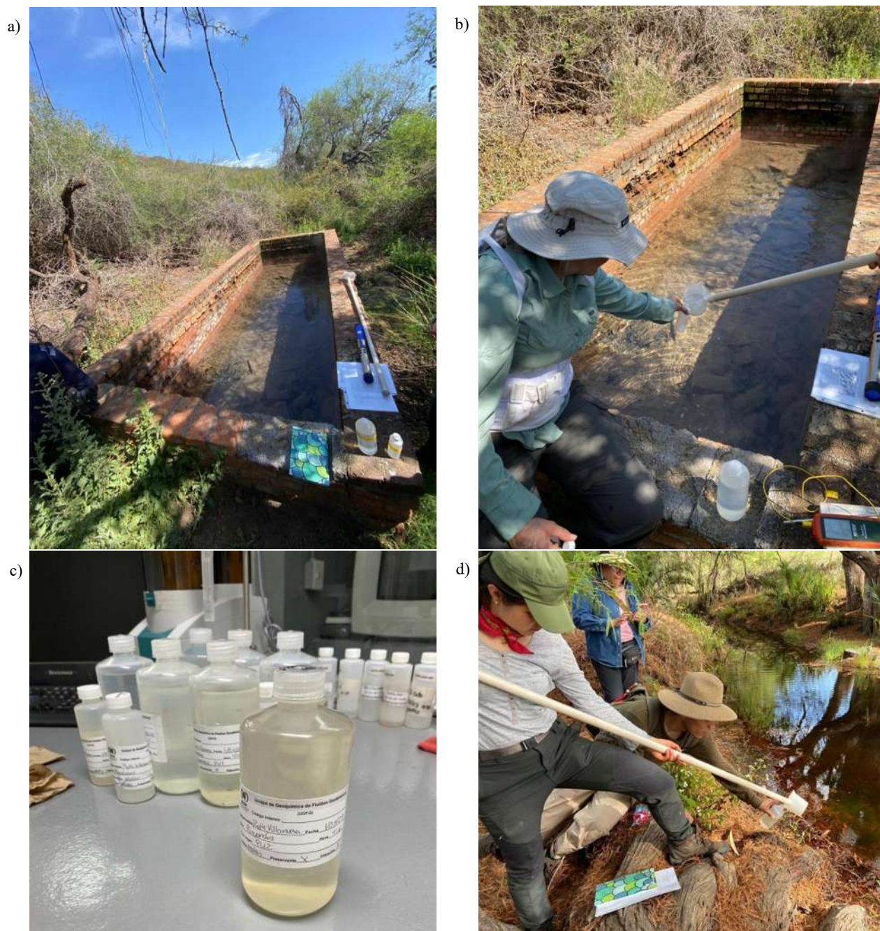
Figura 23. Recolección de muestras para el análisis en el laboratorio de la Unidad de Geoquímica de Fluidos Geotérmicos del Instituto de Geofísica, UNAM, sede morelia. a) Manantial muestreado, b) Colecta de muestras para aniones, cationes y elementos traza, c) Frascos de polipropileno de 250 mL y 125 mL, d) Toma de colecta del río.
