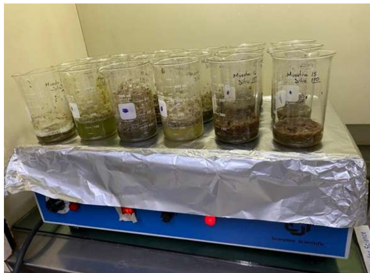
Figura 12. Muestras tratadas con peróxido de hidrógeno ( H_2O_2 ) para la eliminación de materia orgánica.
