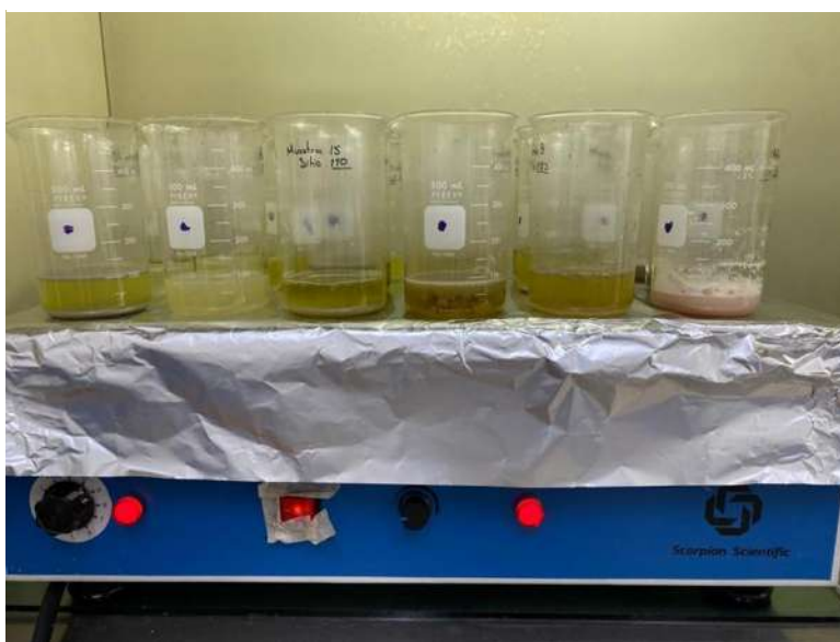
Figura 13. Tratamiento con ácido clorhídrico (HCl) para eliminación de carbonatos; algunas muestras presentan baja efervescencia previa a la reducción de volumen.
