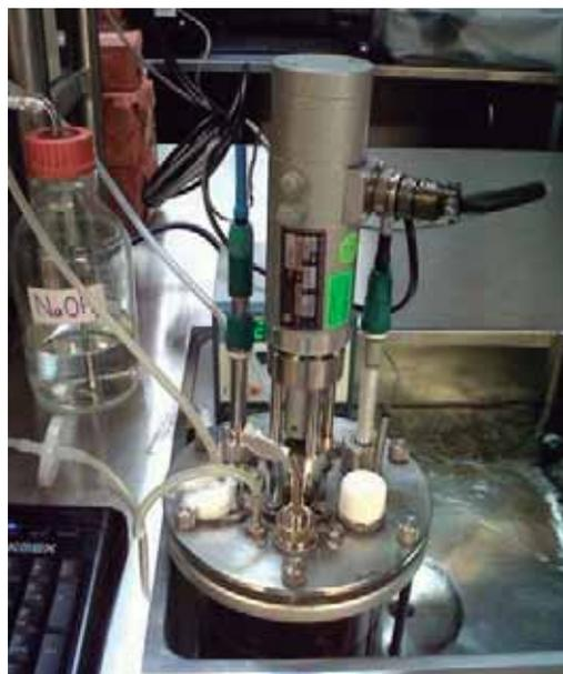
**Figura 17.** Biorreactor en el baño con el termocirculador de inmersión y los sensores de pH, temperatura y oxígeno disuelto.
