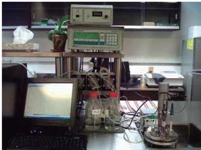
**Figura 16.** Biorreactor conectado a todos los dispositivos de equipamiento.
