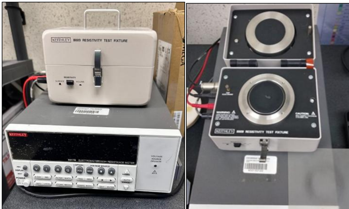
Figura 24 Equipo de medición eléctrica: Método de los cuatro puntos.
