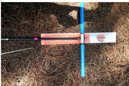
Figura 7. Taladro de Pressler
